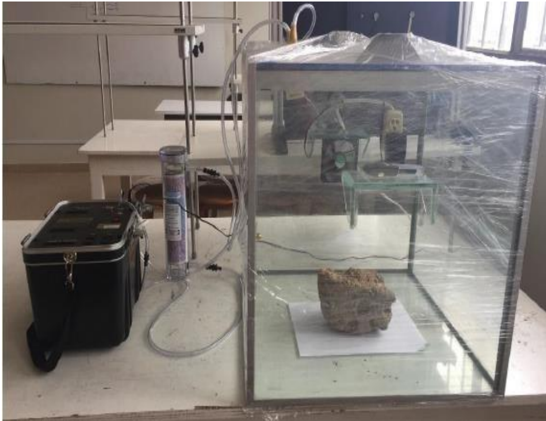
Figura 25: Configuración experimental del método de la cámara cerrada.
