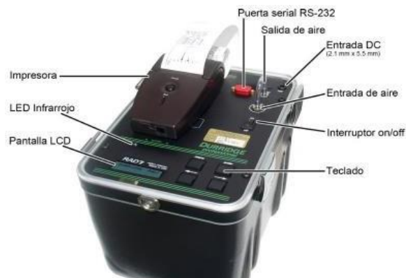
Figura 19: Partes externas del Detector RAD7.
