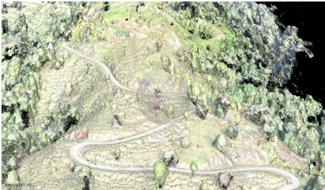
Figura 4. Nube de puntos densa generada por las imágenes de alta calidad tomadas por el drone
