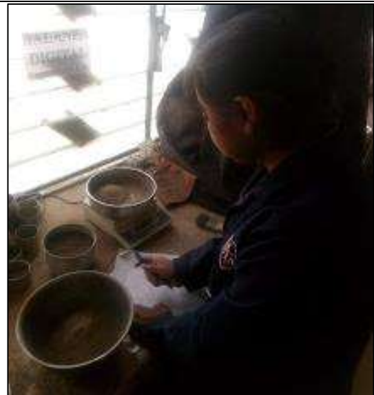
Registrar el peso del material retenido en la fuente.
