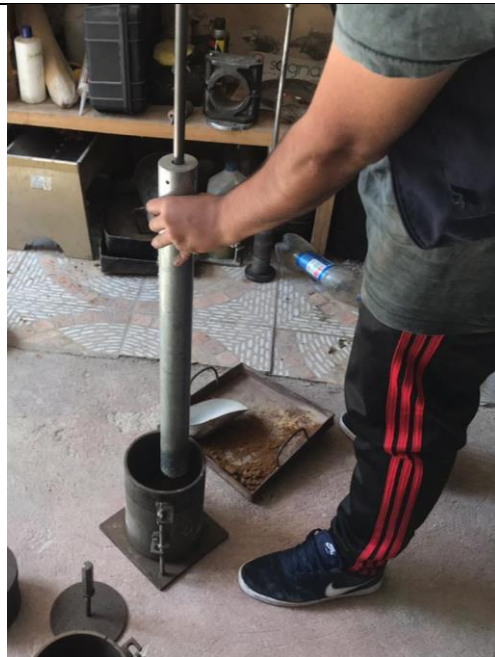
Fotografía 11: Compactación del suelo.
