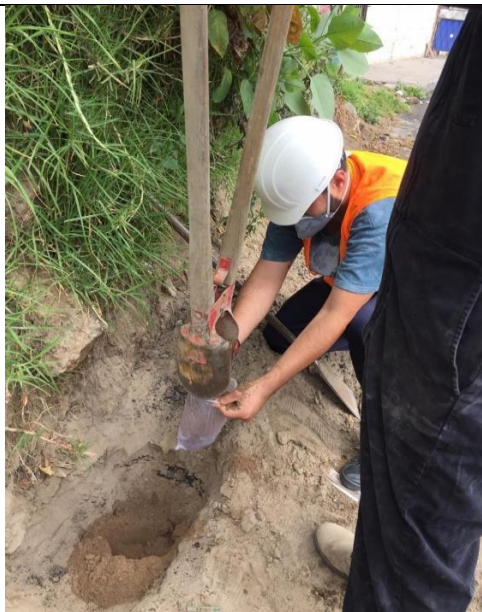
Fotografía 3: Obtención de la muestra de suelo para la ejecución de sus respectivos ensayos.
