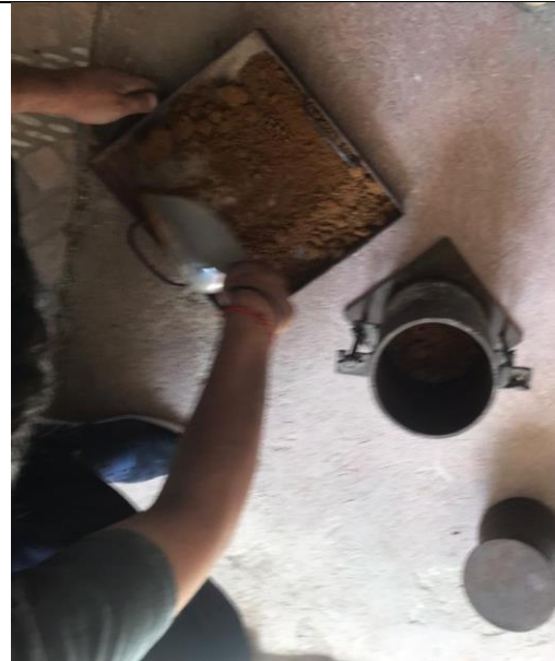
Fotografía 10: Colocación del suelo a ser ensayado en los moldes para el ensayo de compactación.
