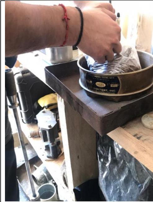
Fotografía 9: Preparación de la muestra de suelo para realizar su tamizado.
