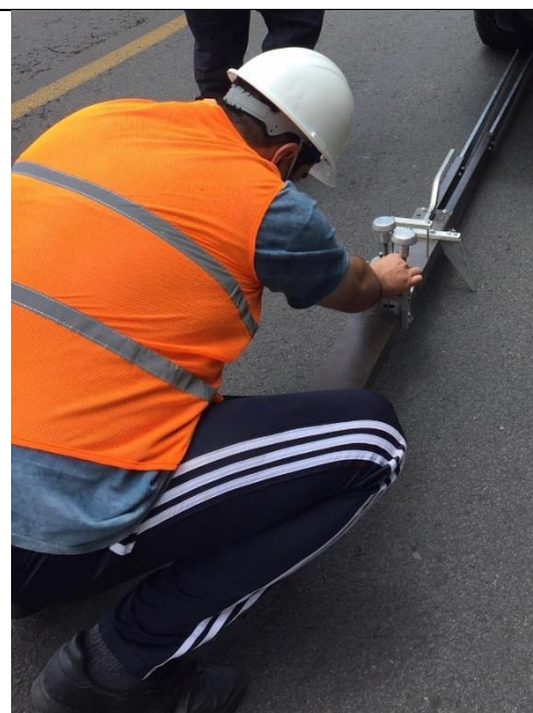
Fotografía 6: Calibración del dial de la viga Benkelman.
