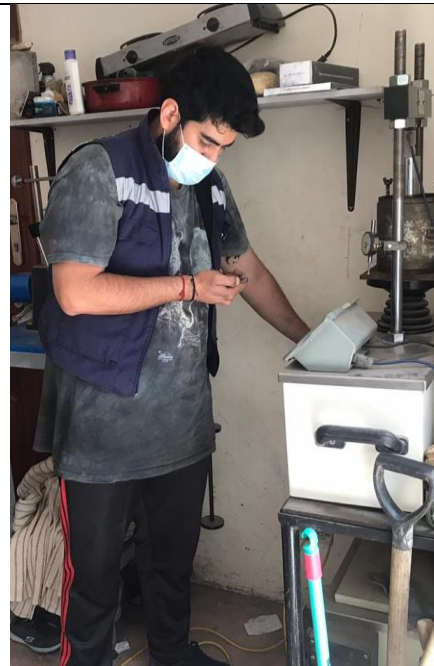
Fotografía 12: Realización del ensayo CBR.
