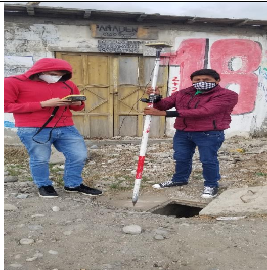
Toma de puntos con TOPCON GMS-2 (GPS+GLONASS)
