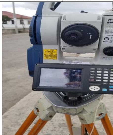
Inicio del levantamiento con estación total
