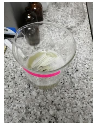
“Lavado” de las muestras con acetona
