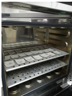
Secado de las muestras para análisis de FDA
