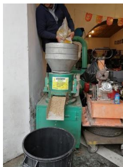
Peletización de balanceado
