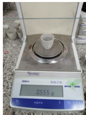
Peso de muestras de heces y alimento en los crisoles
