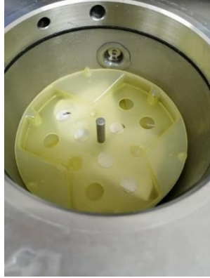
Colocación de las muestras en un analizador de Fibra
