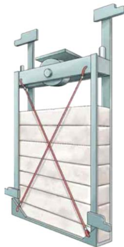
Figura 48. Protección de caída del contrapeso.
