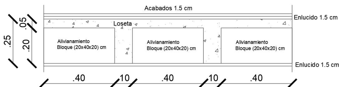
Figura 39: Corte de Losa
