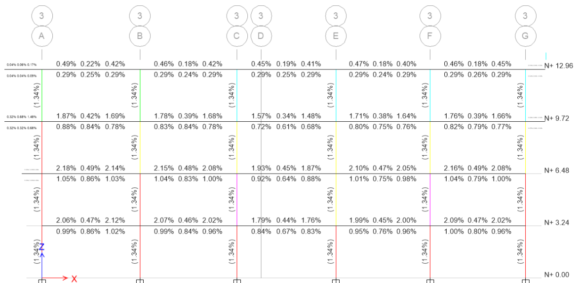
Figura 57: Cuantía de acero en las vigas
