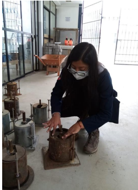
Figura 86. Colocación de pesas en el molde
