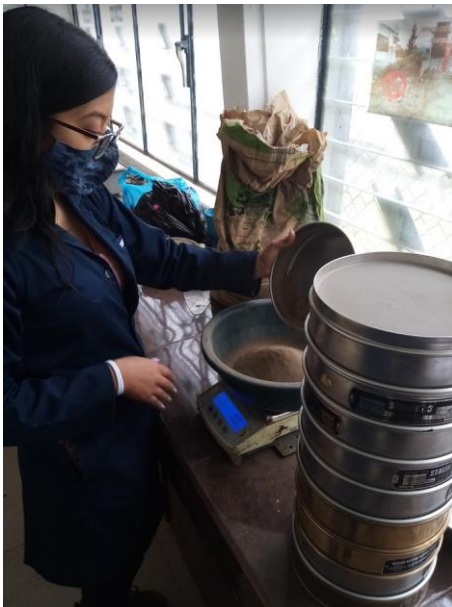
Figura 79. Peso del suelo retenido en cada tamiz
