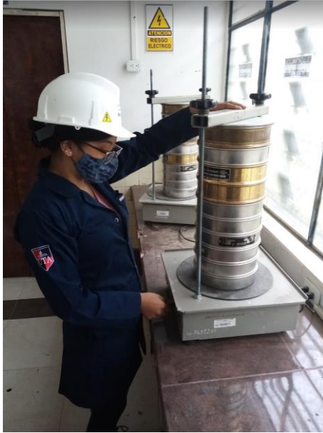
Figura 78. Tamizado de la muestra de suelo durante 15 minutos
