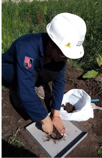
Figura 66. Extracción del suelo
