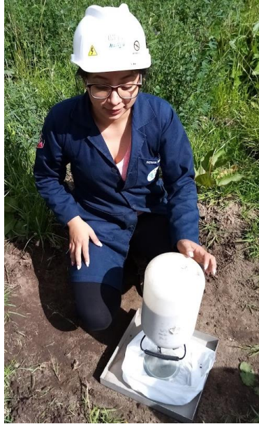
Figura 68. Colocación del cono y arena de Ottawa
