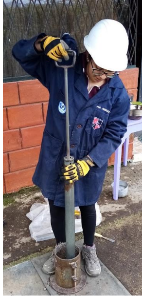
Figura 84. Apisonar con el martillo cada capa de suelo
