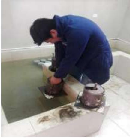
Sumergido en agua de los moldes por 4 días para el ensayo de CBR
