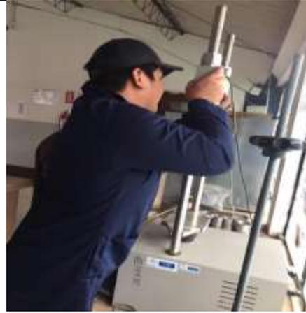
Ubicación de moldes en la máquina de ensayo de CBR
