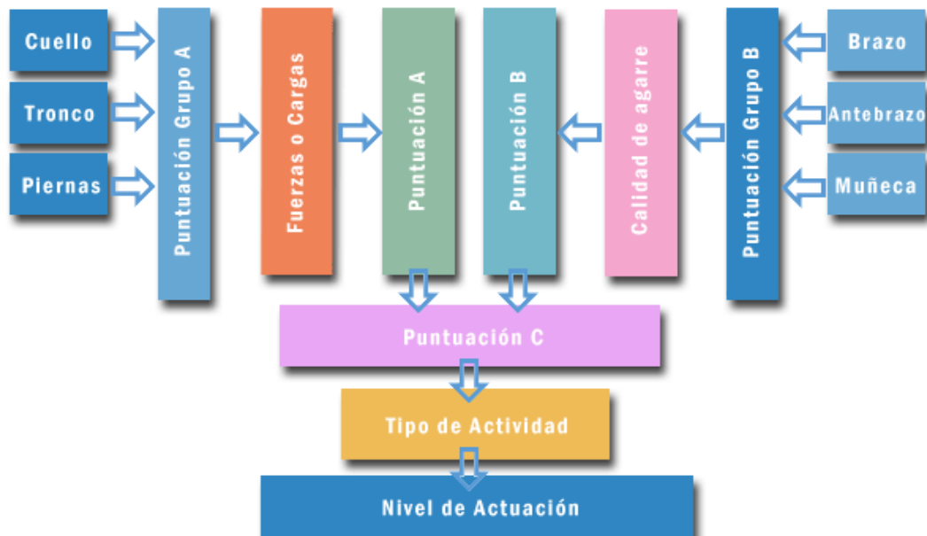
Figura 5. Esquema puntuaciones método REBA
