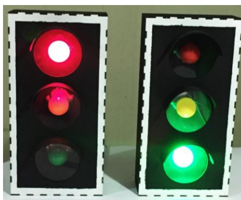
Figura 54: Pruebas de funcionamiento de los semáforos inteligentes A y B conectados al sistema de control de tráfico vehicular.
