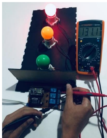
Figura 38: Pruebas de funcionamiento de los elementos del circuito en la placa electrónica mediante el multímetro digital.
