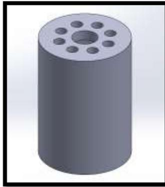
*Figura 31: Estabilizador de llama.*
