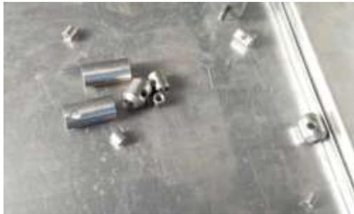
*Figura 30: Partes en mecanizado por torno convencional.*
