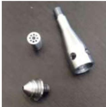
*Figura 38:Partes mechero de gas según UNE-EN ISO.*
