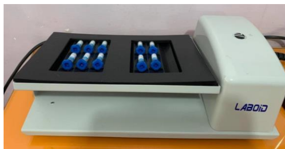
Fotografía 18. Muestras en el Agitador orbital (LABOID LRP 71)
