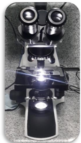
Foto 6. Se coloca el sedimento entre porta y cubre objetos y pasa a ser leído en microscopio.
