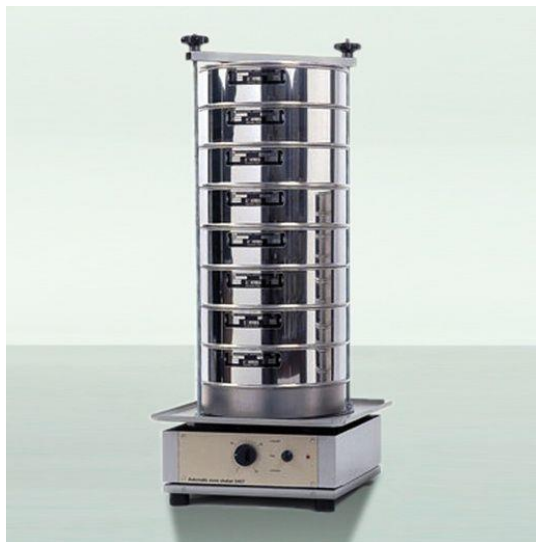
Figura 2: Conjunto de tamices para una prueba en el laboratorio.
