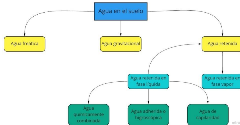
Figura 5: Agua en el suelo
