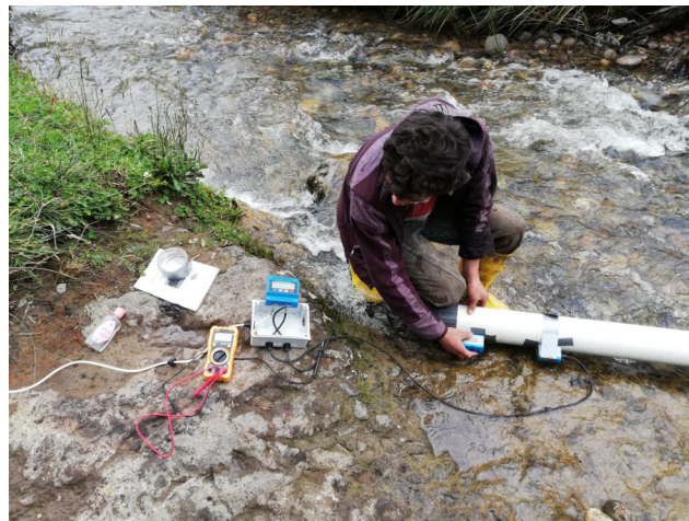
Figura 46: Desplazar el sensor a lo largo de la tubería hasta que el sensor marque las mediciones de caudal
