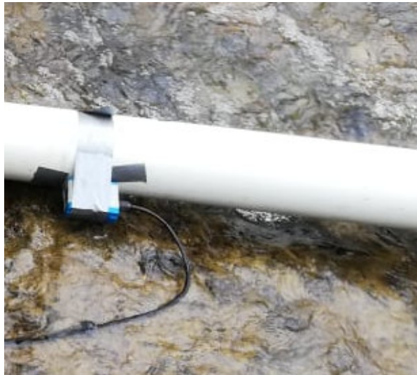
Figura 45: Ubicar el primer sensor aguas arriba
