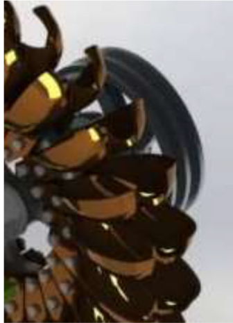
Figura 14: Álabes de una turbina Pelton, empernadas al rodete.
