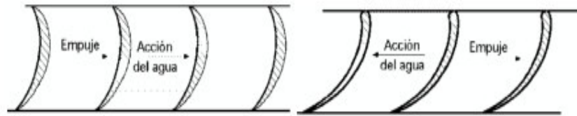
Figura 8: a) Diagrama de turbinas de acción. b) Diagrama de turbinas de reacción.
