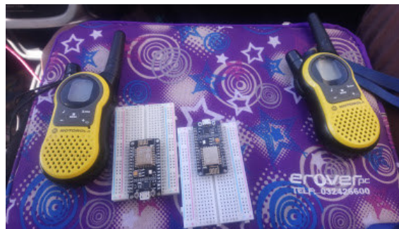
Figura 48: Módulo ESP8266 servidor y cliente para prueba de señal
