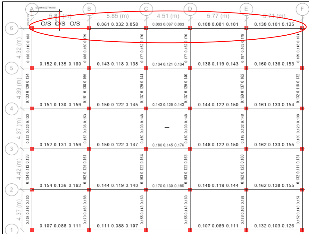
Figura N° 85: Corte máximo de demanda en viga V2, ubicado en el sentido X, nivel
