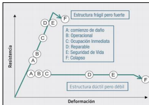
Figura N° 23: Niveles de desempeño de diferentes estructuras deficientes
