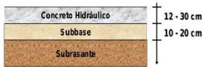
Figura 2: Sección transversal de pavimento rígido
