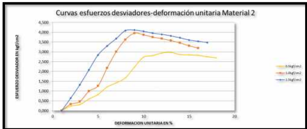
Figura 14: Curvas Esfuerzo vs Deformación, Ensayo Triaxial - Material 2
