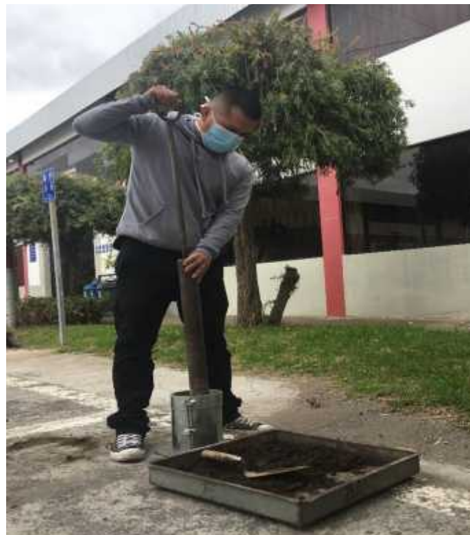
Figura 73: Ensayo Proctor modificado
