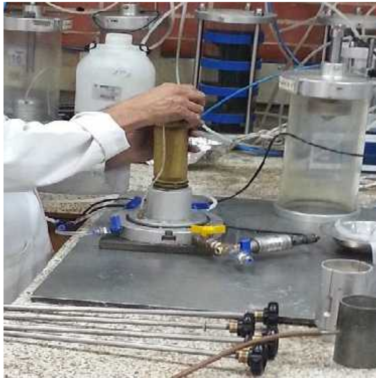
Figura 88: Preparación ensayo triaxial
