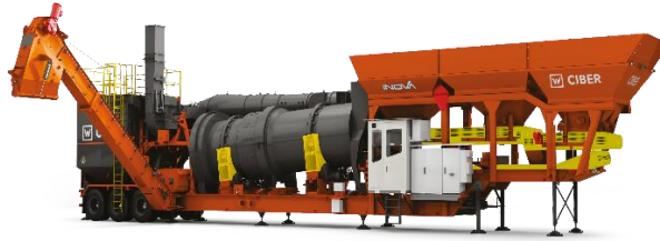
Gráfico 21. Planta Asfáltica de secado a contra flujo
