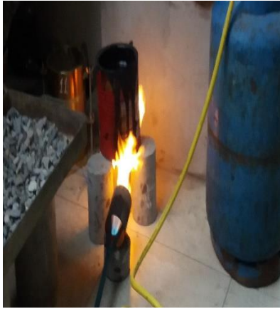
Temperatura de los agregados (140°C-150°C)
