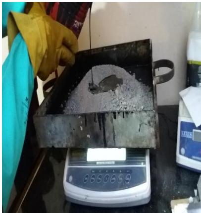
Calentando la mezcla de Agregados y Asfalto
