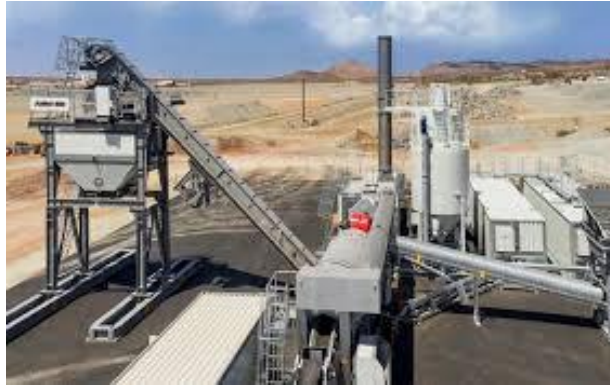
Gráfico 19. Planta de asfalto continua de flujo paralelo Fuente: Amman (2018)
