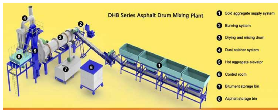
Gráfico 23. Planta asfáltica tipo drum-mix Fuente: Asphalt Mixing Plant
