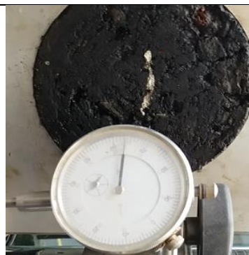
Ensayo de Estabilidad y Flujo
