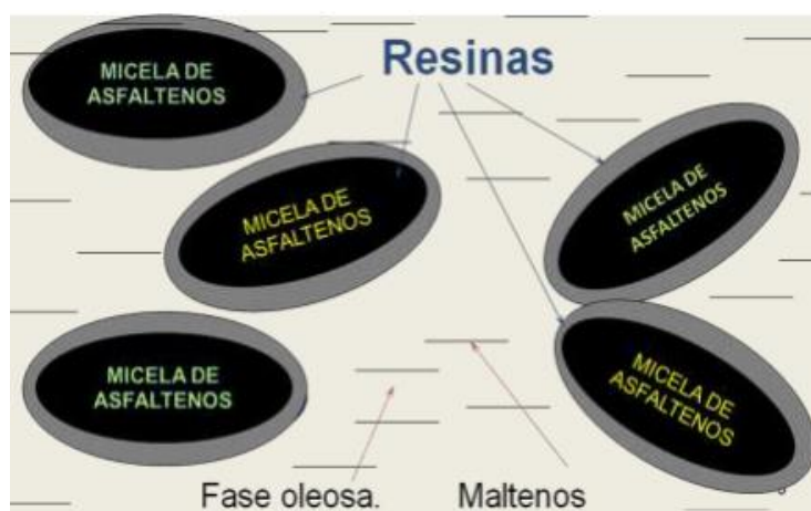
Gráfico 8. Subclasificación Química del Asfalto Fuente: Cepeda (2014)
