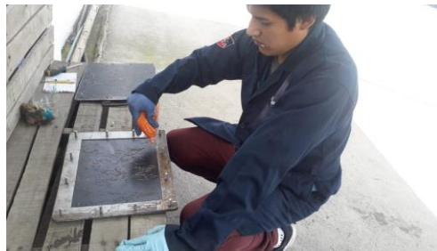
Figura 38: Implementación de la cera en el molde.
