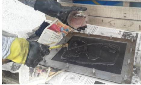
Figura 43: Colocación de resina poliéster
