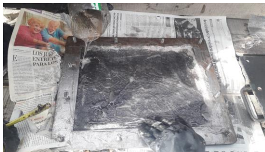
Figura 45: Aplicación de la resina en la fibra de vidrio
