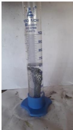
Figura 25: Medición de malla galvanizada y agua.
