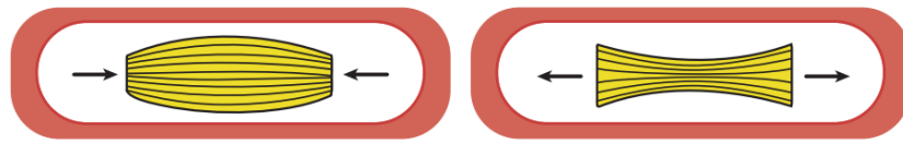
Figura 2: Cargas de compresión y tracción en el material compuesto. [12]
