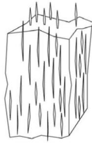
Figura 5: Compuesto conformado con refuerzo de whiskers. [17]
