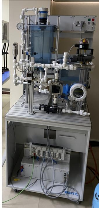
Figura 25: Planta FESTO MPS PA de la Facultad de Ingenieria en Sistemas
