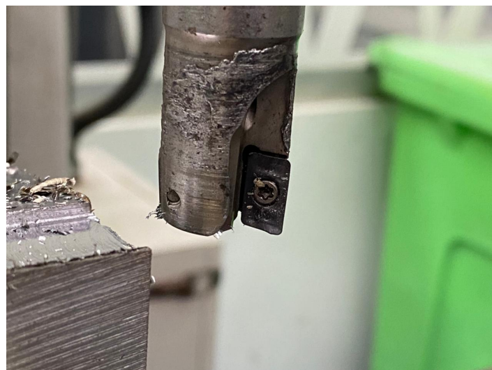
Ilustración 4.4. Desbastado en la fresadora
