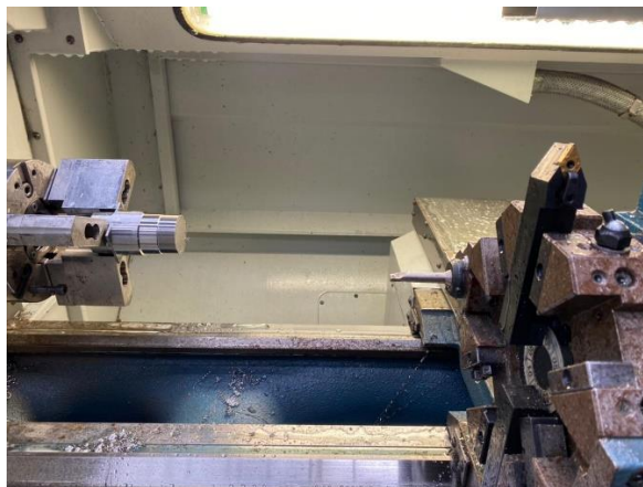
Ilustración 4.1. Desbaste de los extremos de la pieza
