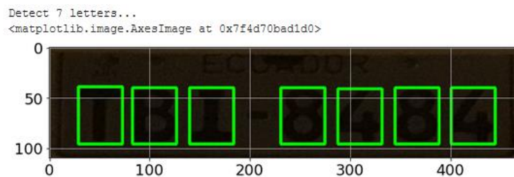
Figura 4-27: Componentes de la imagen, configurando su alto y ancho
