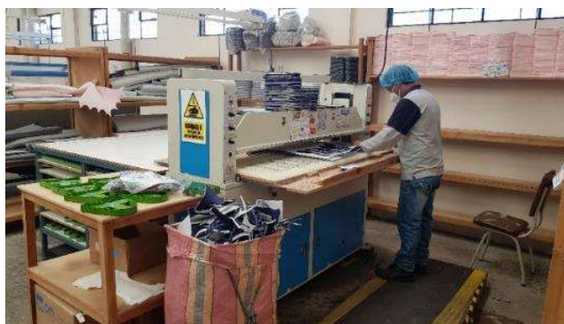
Figura 10.- Proceso de corte, Troqueladora 02.
