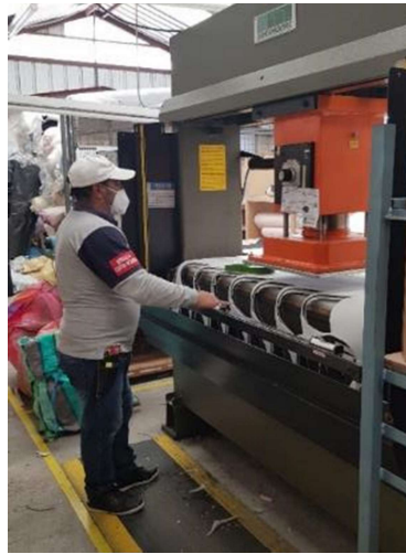
Figura 11.- Proceso de corte, Troqueladora 01.
