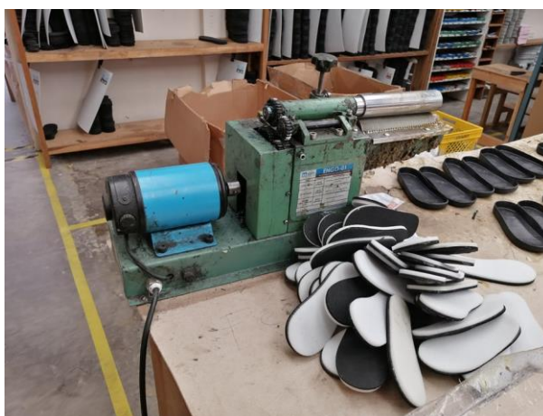
Figura 29: Máquina del engomado de costura lateral.
