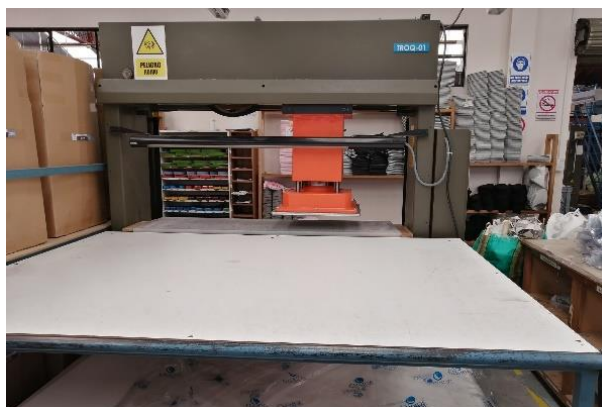
Figura 24: Troqueladora 01 para el corte de forros y rellenos.
