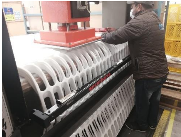
Figura 27: Corte de piezas para el relleno de la pantufla
