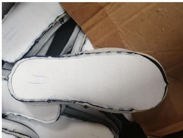
Figura 34: Pantufla armada tipo embolsado y costura lateral.
