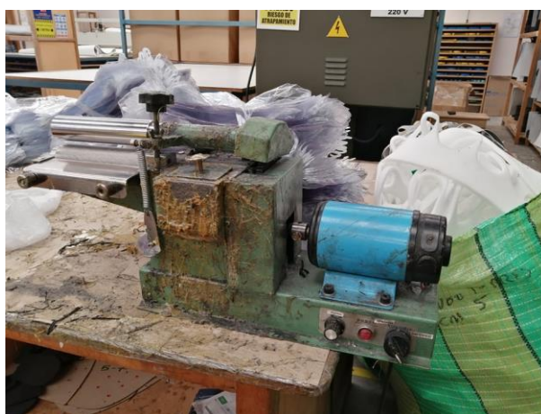
Figura 30: Máquina del engomado del embolsado.
