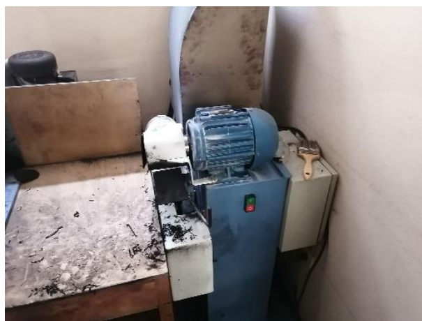
Figura 28: Máquina para el pulido de los tacones eva.
