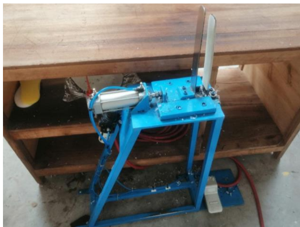
Figura 36: Herramientas para el volteado de la pantufla.
