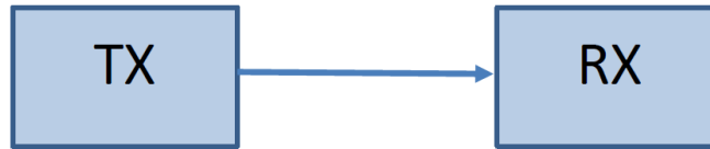
Figura 2.4 Modelo de Tx SIMPLEX [18]
