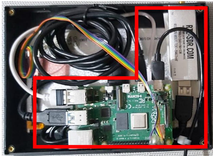
Figura 4.7 Conexión Raspberry y RTL-SDR
