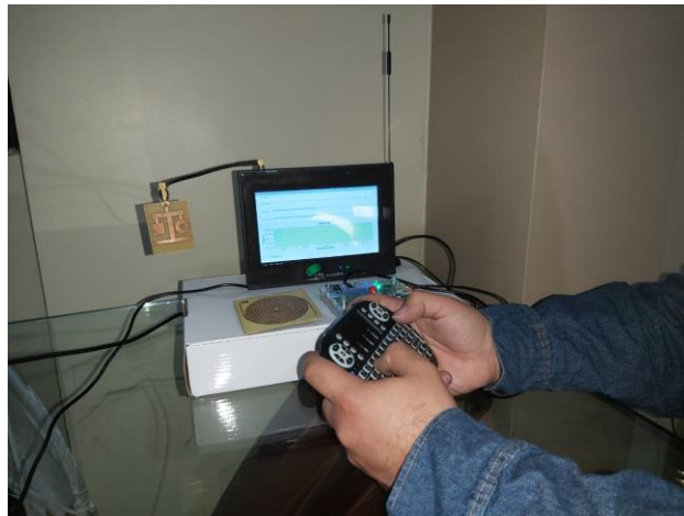
Figura 4.67 Conexión de prototipo a antena HRPSA.
