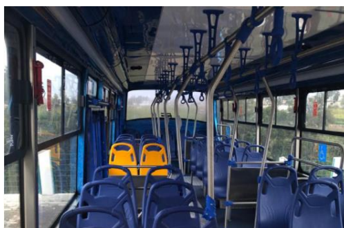
Figura 18. Colocación de pasamanos.
