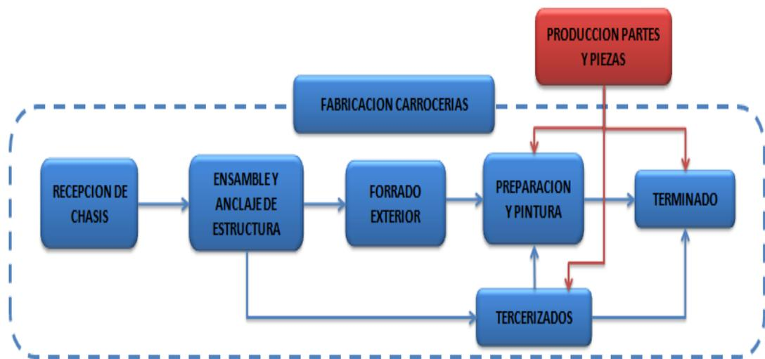
Figura 4-2: Subprocesos Fabricación de Carrocerías.
