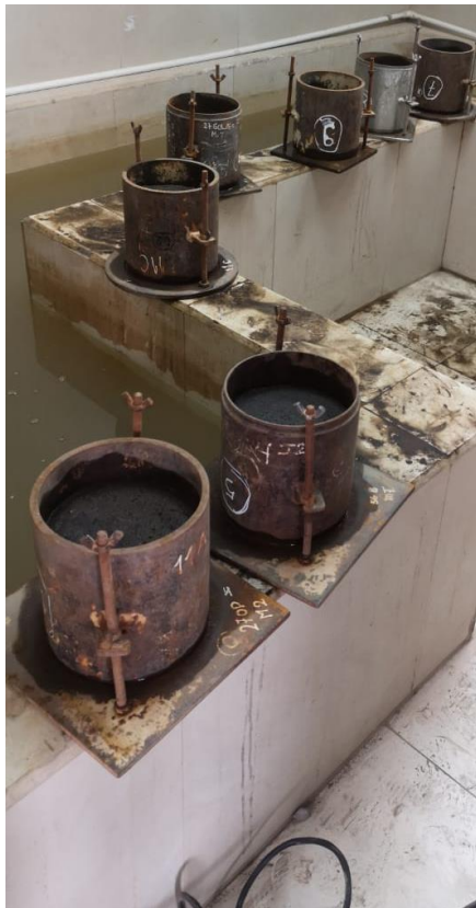
Figura 72. Muestras de suelo para sumergirlo
