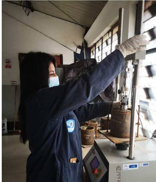
Figura 73. Colocación del cilindro en la máquina de compresión simple
