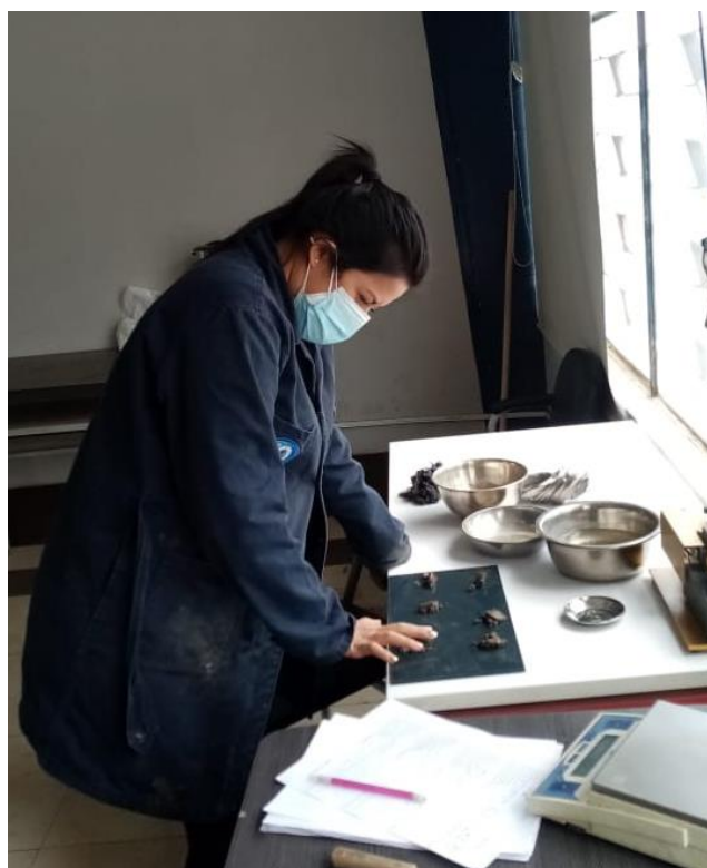
Figura 69. Realización de los rollitos con el suelo
