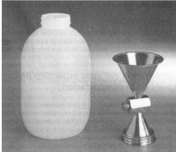
Figura 9. Recipiente de plástico y el cono metálico para el ensayo del cono y arena
