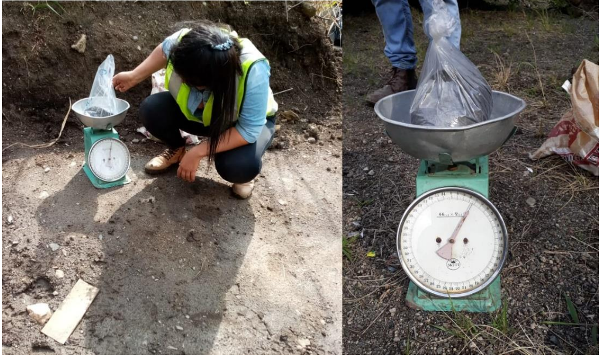
Figura 24. Peso del cono y la muestra extraída
