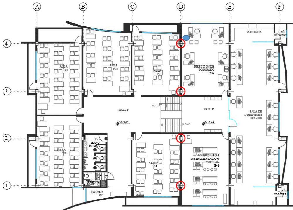
Figura 111: Ubicación de columnas a reforzar
