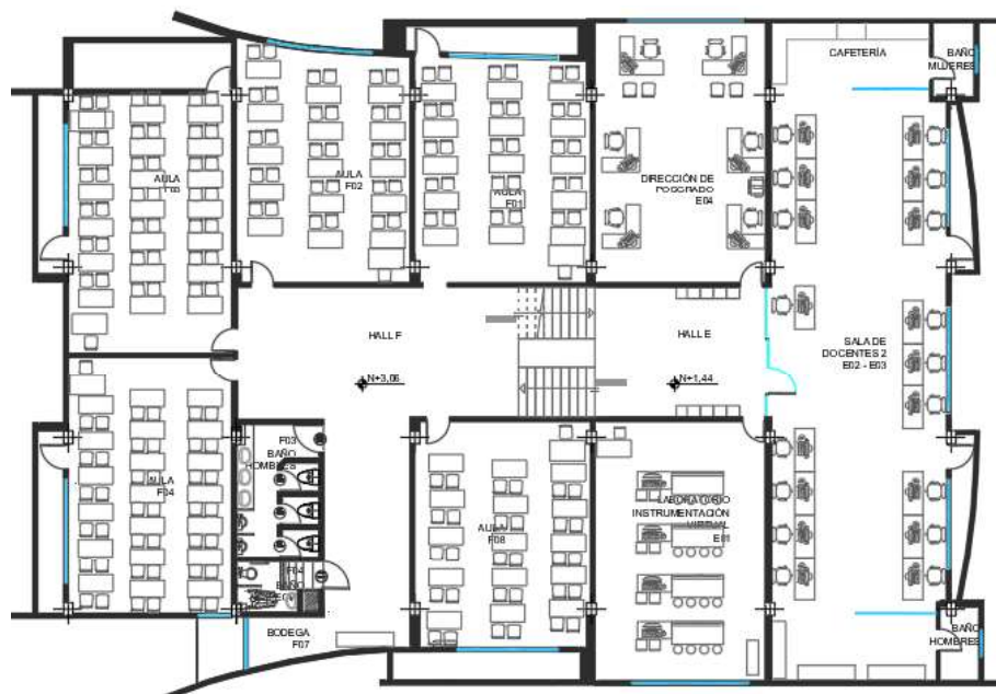
Figura 23: Plano arquitectónico segundo piso
