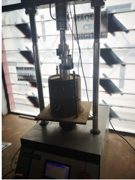
Figura 38: Aplicación de carga sobre la muestra para la obtención del CBR. Autor: José Luis López Sánchez.
