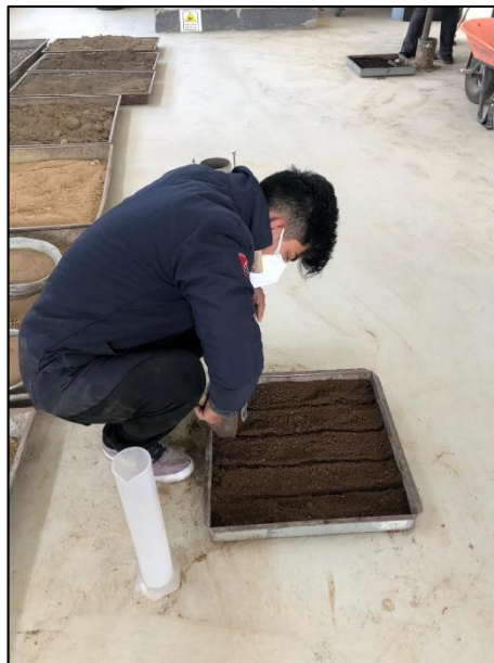
Figura 79: Mezclando adecuadamente el suelo para el ensayo de Próctor Modificado. Autor: José Luis López Sánchez.
