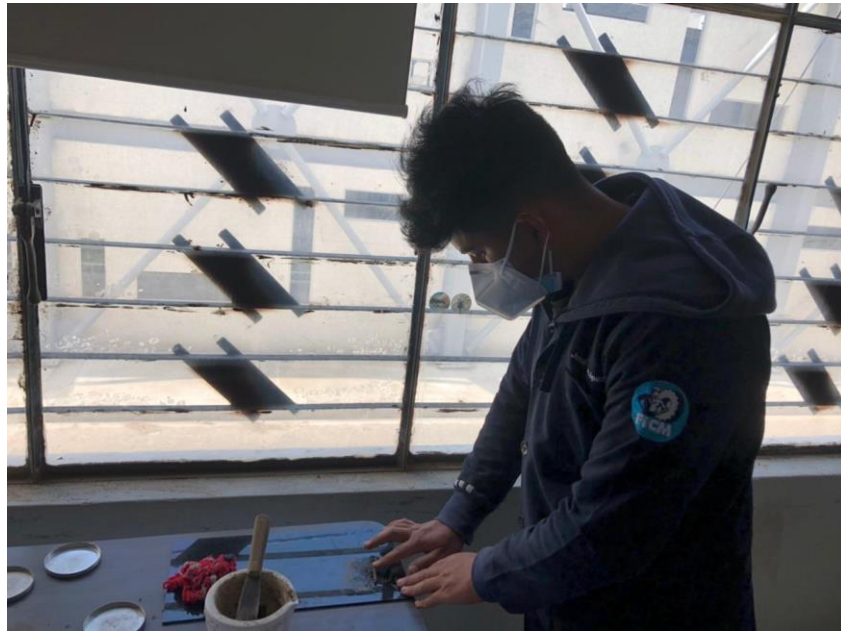
Figura 36: Realización de los rollitos de 3 mm para la determinación del límite plástico. Autor: José Luis López Sánchez.
