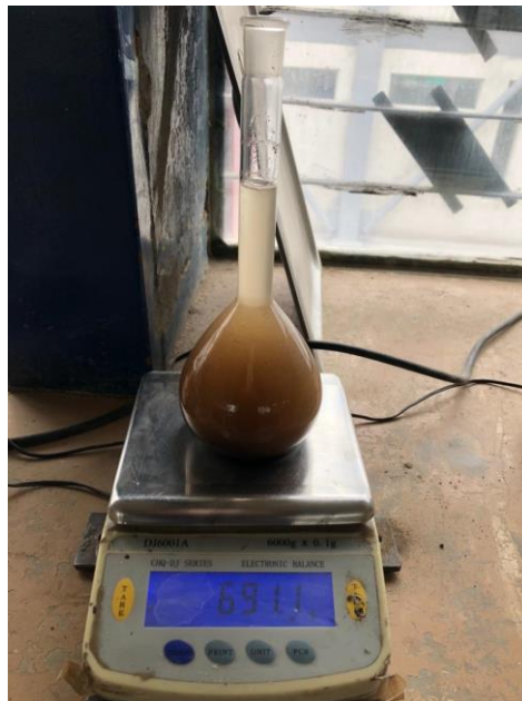
Figura 33: Determinación de la gravedad específica. Autor: José Luis López Sánchez.
