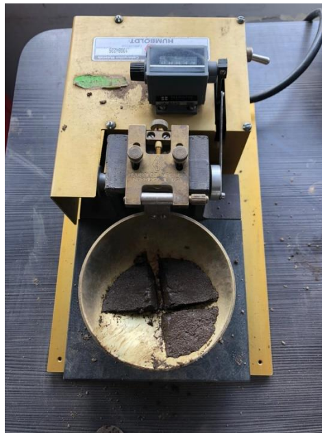
Figura 35: Toma de muestra para la obtención del límite líquido. Autor: José Luis López Sánchez.
