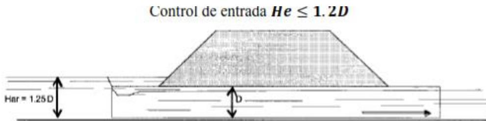
Figura 56 Control a la entrada de alcantarilla
