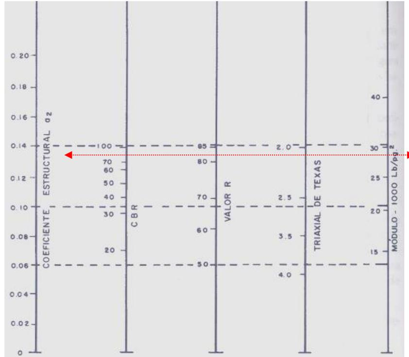
Figura 38 Valores del coeficiente estructural (ab) para bases granulares no-tratadas
