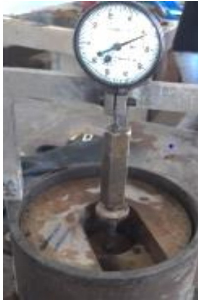
Figura 34: Ensayo de CBR (California Bearing Ratio)
