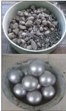
Imagen 3.- Colocar el material y la carga abrasiva en la máquina de los ángeles
