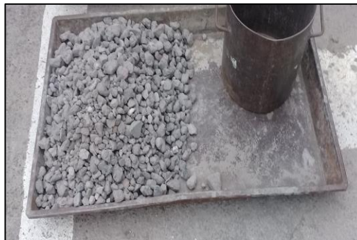
Figura 20: Densidad Aparente Suelta de los agregados
