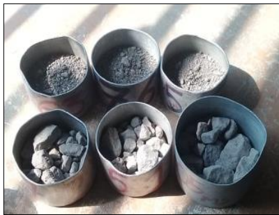
Imagen 3.- Colocar la muestra de suelo húmedo en los recipientes
