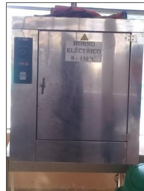
Imagen 2.- Lavar el material y secar en el horno 24 horas antes del ensayo
