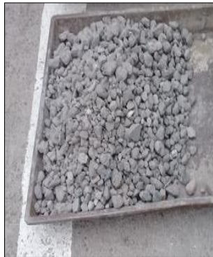
Imagen 1.- Situar el agregado grueso en una bandeja
