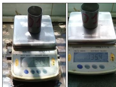
Imagen 11.- Tomar dos muestras de agregado fino en estado SSS y colocar en el horno durante 24 horas
