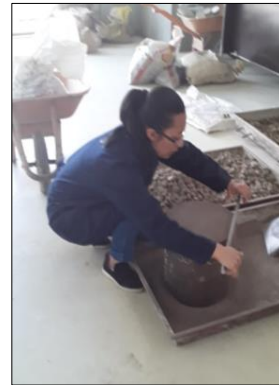
Imagen 4.- Enrazar el exceso de material
