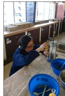
Imagen 6.- Medir la longitud de la muestra
