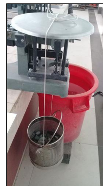
Imagen 6.- Pesar la canastilla más suelo (en el aire)
