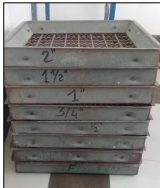
Figura 19: Granulometría del agregado grueso
