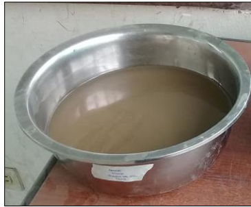
Imagen 1.- Sumergir la muestra 24 h antes del ensayo
