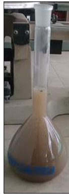
Imagen 7.- Introducir agua en el picnómetro
