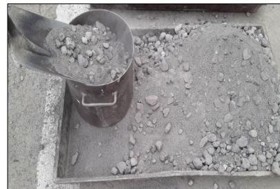
Imagen 4.- Agregar el material en el recipiente en 3 capas y compactar cada una de ellas con 25 golpes
