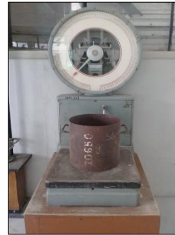
Imagen 2.- Pesar el recipiente vacío
