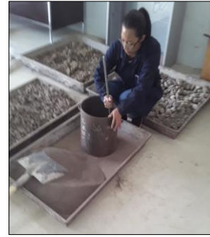
Imagen 2.- Añadir el material en 3 capas y compactar cada una de ellas con 25 golpes
