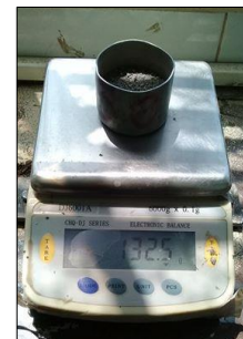
Imagen 12.- Pesar las muestras secas de suelo
