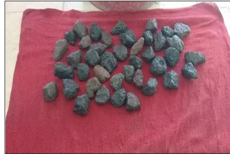
Imagen 2.- Retirar el exceso de agua con ayuda de una franela
