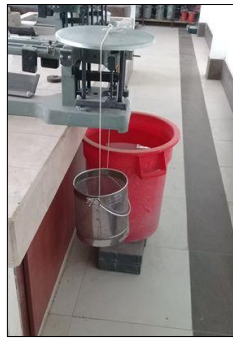
Imagen 3.- Pesar la canastilla vacía al aire
