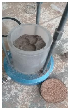
Imagen 5.- Compactar debidamente cada una de las capas y colocar otra piedra porosa
