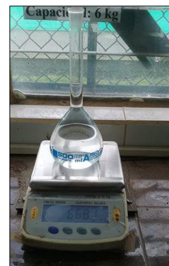
Imagen 10.- Pesar el picnómetro más 500cc de agua
