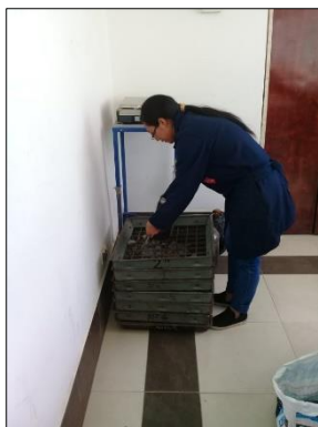
Imagen 3.- Colocar el suelo sobre los tamices
