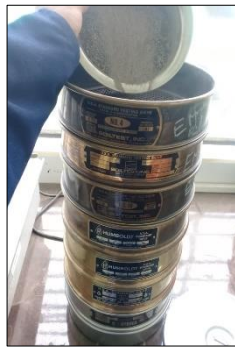
Imagen 3.- Colocar el suelo sobre los tamices
