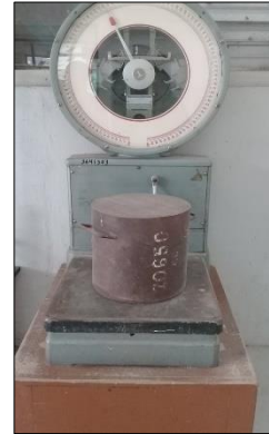
Imagen 4.- Pesar el conjunto recipiente más agregado compactado
