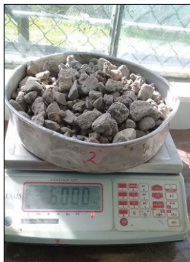
Imagen 1.- Seleccionar la muestra de suelo y pesar
