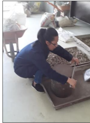
Imagen 3.- Enrazar el exceso de material
