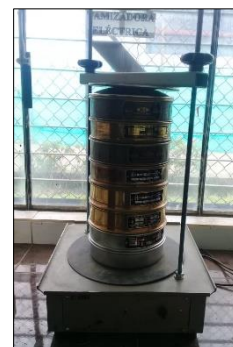
Imagen 4.- Llevar a la tamizadora de 10 a 15 minutos
