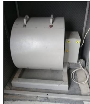
Imagen 4.- Cerrar la máquina y girar con un total de 500 vueltas
