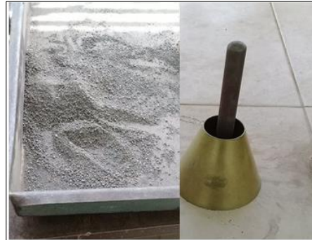
Imagen 4.- Comprobar que el material alcanzó la condición de Saturado Superficie Seca (SSS), mediante el ensayo del cono y el pisón
