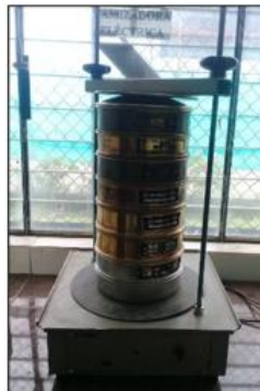
Figura 18: Granulometría del agregado fino
