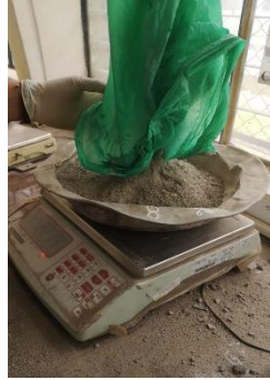
Imagen 1.- Pesar las cantidades requeridas de cada material
