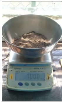
Imagen 1.- Seleccionar la muestra de suelo y pesar
