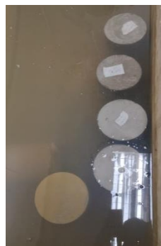
Imagen 5.- Curar las probetas de hormigón durante 28 días a 125 ° C
