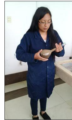
Imagen 8.- Girar el picnómetro hasta extraer el aire
