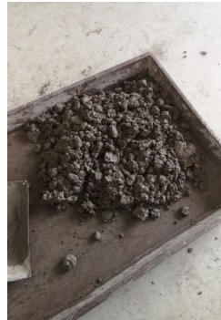
Imagen 3.- Verter el hormigón en una bandeja previamente humedecida
