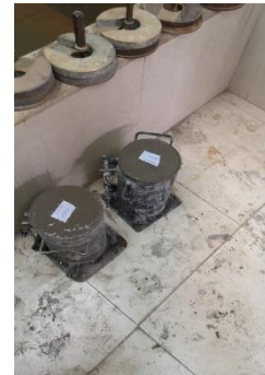
Imagen 4.- Colocar la mezcla en los moldes
