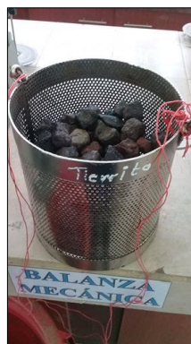
Imagen 5.- Colocar el suelo saturado superficie seca en la canastilla
