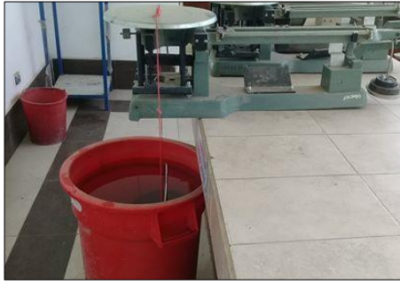
Imagen 7.- Pesar la canastilla más suelo sumergido (en el agua)
