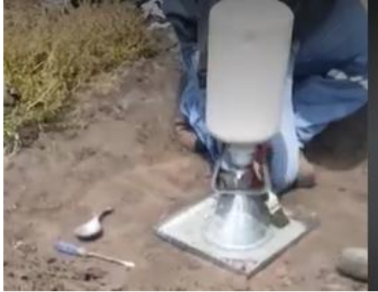
Figura 55. Ejecución Ensayo densidad de Campo
