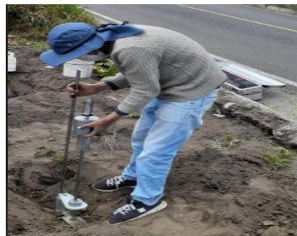
Figura 54. Ejecución Ensayo DCP
