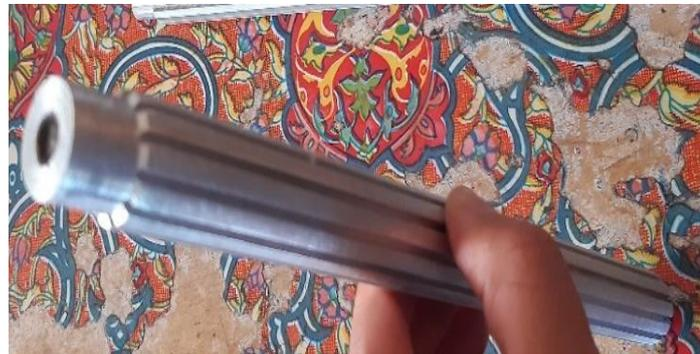
**Plancha de cobre (Superficies extendidas Axiales)**
