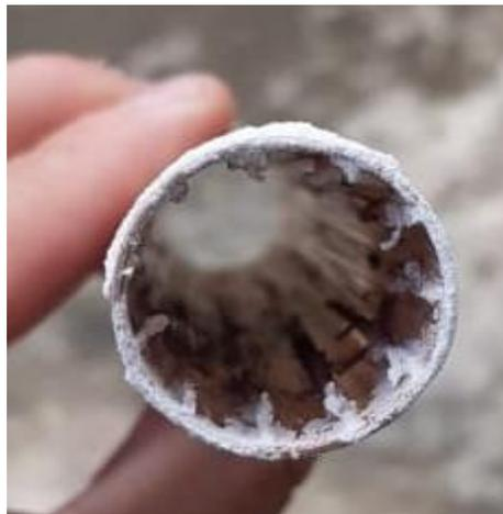
**Estructuración de Surcos (prueba con polvo de cobre)**
