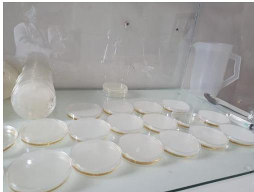
**Figura 3.** Dispensación de medios de cultivo en condiciones de cabina de flujo laminar
