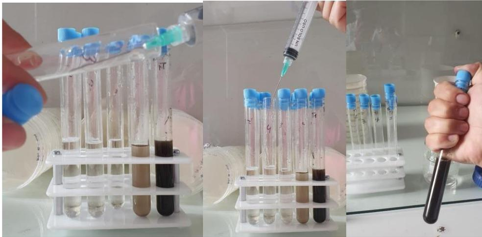
**Figura 6** Realización de las diluciones en gradillas que contenía los tubos de ensayo y sus diluciones seriadas.
