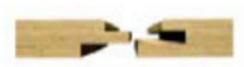
Ilustración 31: Montaje tipo machihembrado Fuente: (MACISA, 2017)
