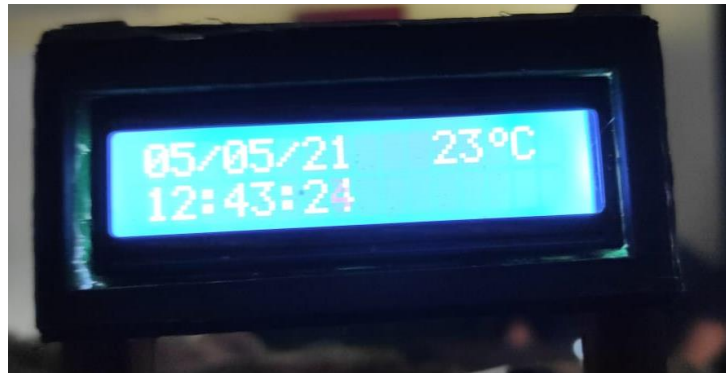
Figura 46. Temperatura, fecha y hora en la pantalla LCD
