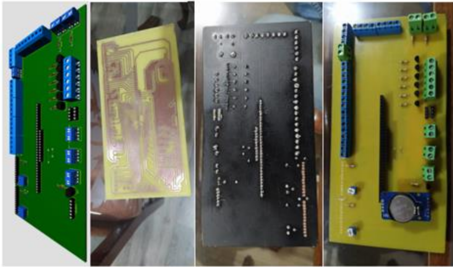
Figura 42. Elaboración de la placa electrónica
