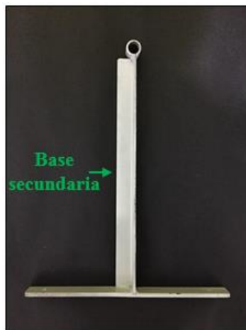
Figura 31 Base secundaria de la estructura del seguidor solar fotovoltaico.
