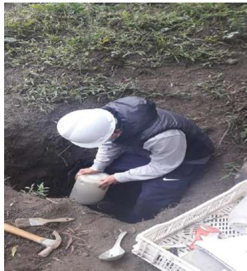
Figura 10. Ensayo de densidad de campo de la vía Baños-Loma Chontilla
