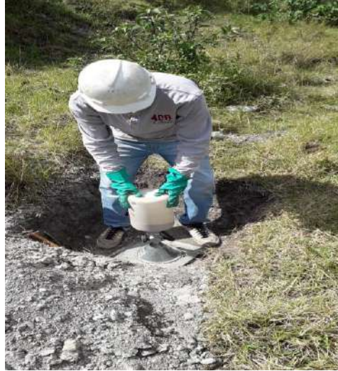
Figura 10. Ensayo de densidad de campo de la vía Baños-Loma Chontilla
