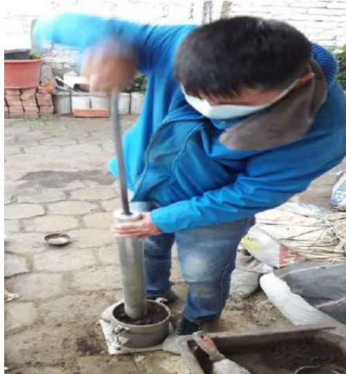
Figura 14. Realización de Proctor Modificado
