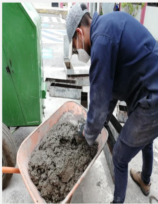
Fotografía 33. Pesaje de materiales para vigas de hormigón tradicional
