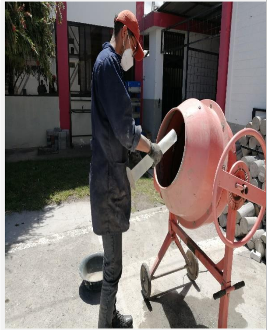
Fotografía 42. Vertido del aditivo en la mezcla
