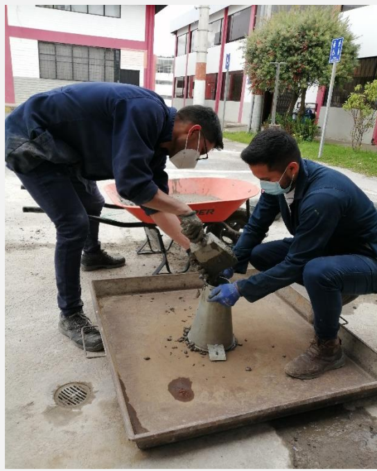
Fotografía 53. Colocación de mezcla en cono de Abrams para realización del ensayo “Slump Flow”
