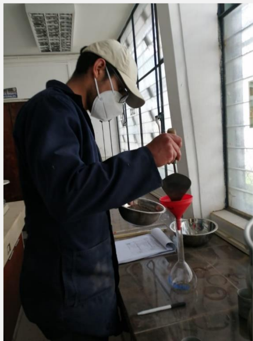
Fotografía 14. Utilización del cono truncado para determinar estado SSS del agregado fino
