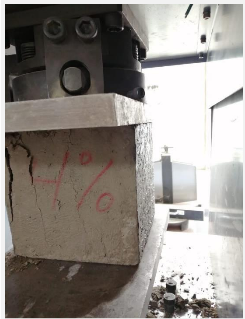
Fotografía 84. Rotura de cubo con el 4% de fibra óptica
