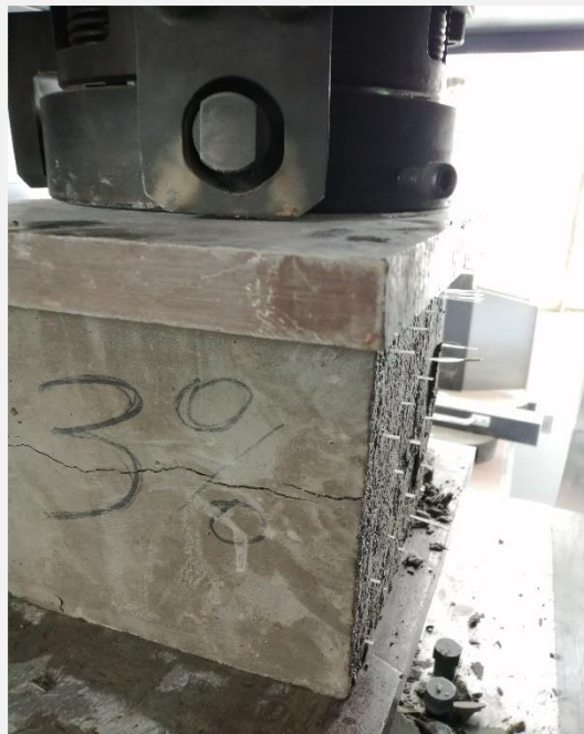
Fotografía 83. Rotura de cubo con el 3% de fibra óptica
