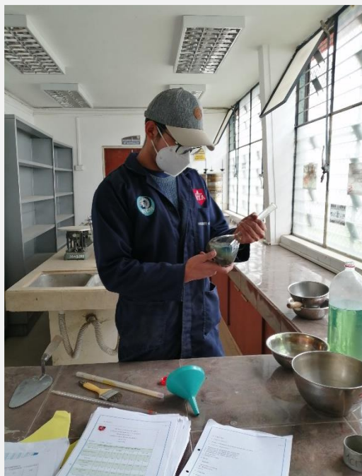
Fotografía 7. Quitando las burbujas de aire agitando el picnómetro
