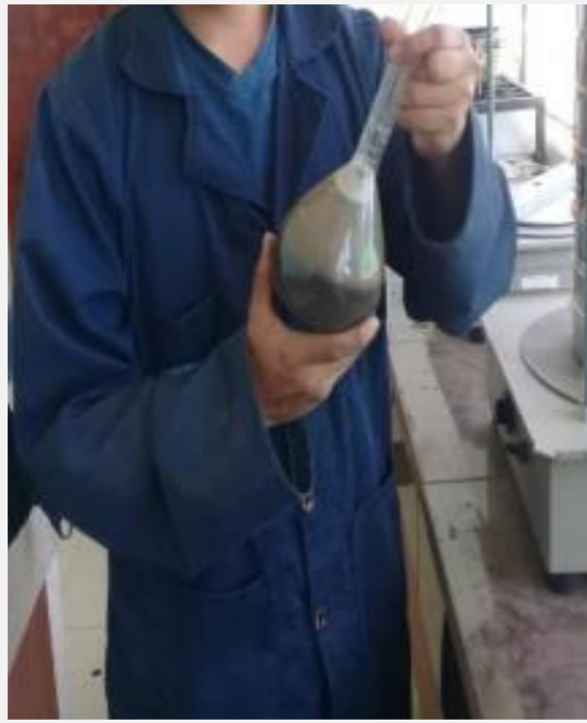
Fotografía 17. Eliminando los vacíos de la muestra en SSS más agua
