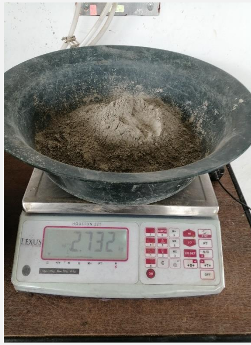
Fotografía 25. Pesaje de materiales para dosificación de hormigón tradicional
