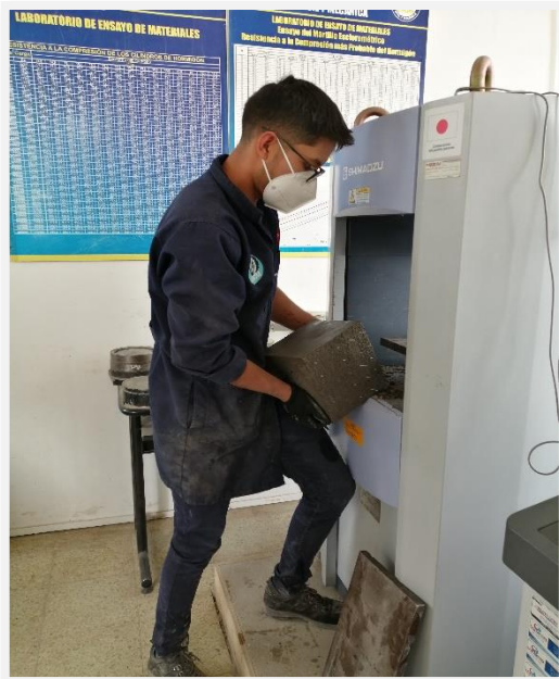
Fotografía 82. Colocación de los cubos de hormigón translúcido
