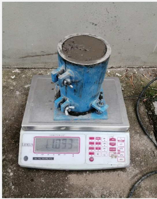
Fotografía 57. Pesaje de cilindros con hormigón autocompactante
