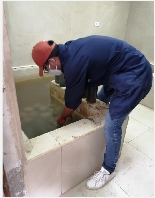
Fotografía 58. Colocación de cilindros en cámara de curado
