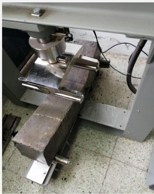
Fotografía 85. Rotura de cubo con el 5% de fibra óptica
