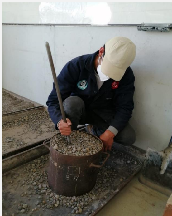
Fotografía 23. Compactación de los agregados
