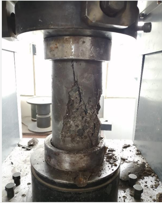
Fotografía 81. Rotura de los cilindros
