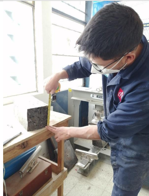
Fotografía 88. Medición de las dimensiones en donde se produjo la rotura
