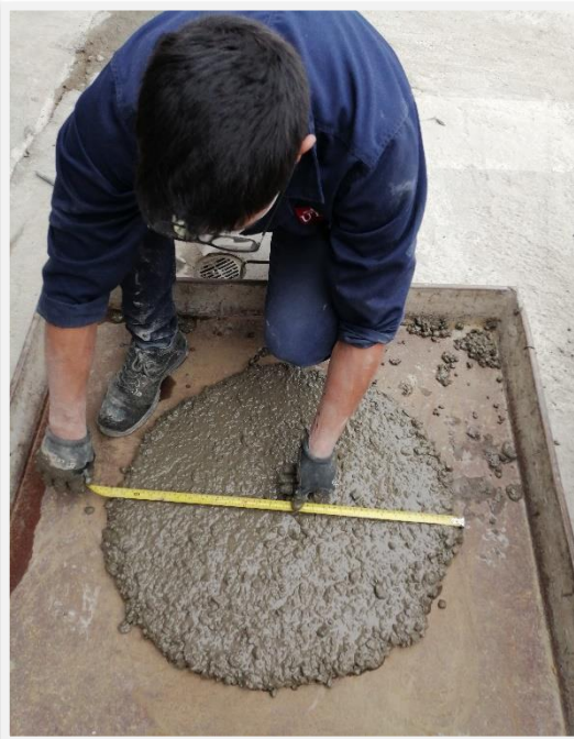
Fotografía 56. Medición de diámetro perpendicular
