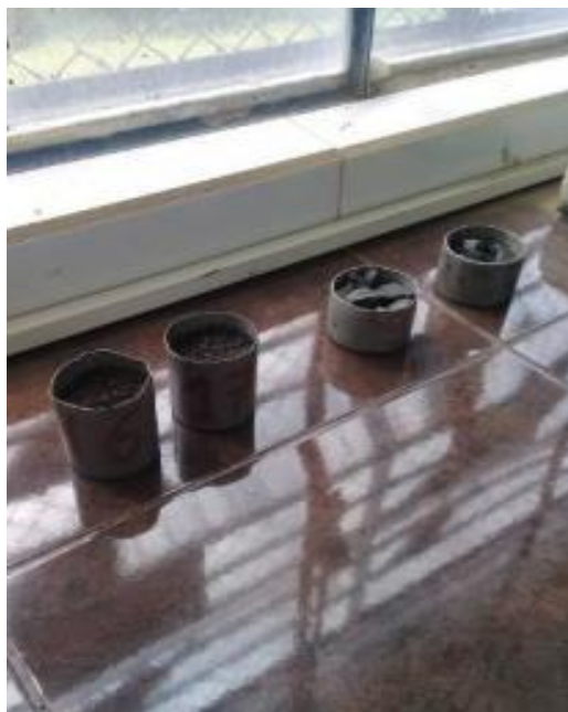
Fotografía 19. Preparación de muestras para contenido de humedad
