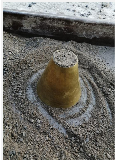
Fotografía 14. Utilización del cono truncado para determinar estado SSS del agregado fino
