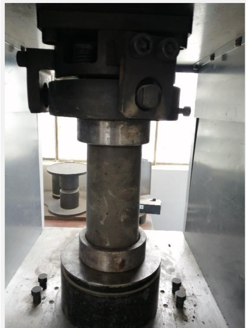
Fotografía 80. Posicionamiento del cilindro para iniciar el ensayo
