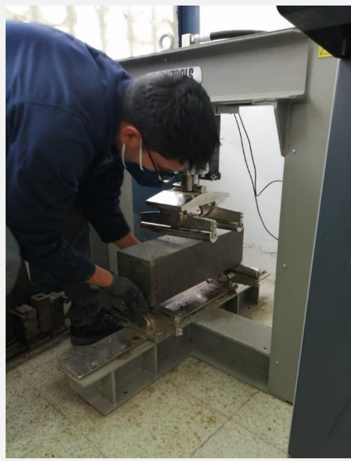
Fotografía 89. Colocación de la viga de hormigón translúcido
