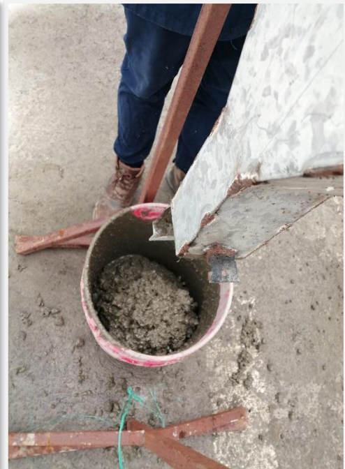
Fotografía 52. Finalización del ensayo Embudo V
