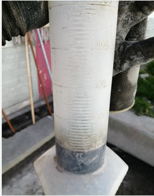
Fotografía 41. Verificando la cantidad de aditivo superplastificante a implementar
