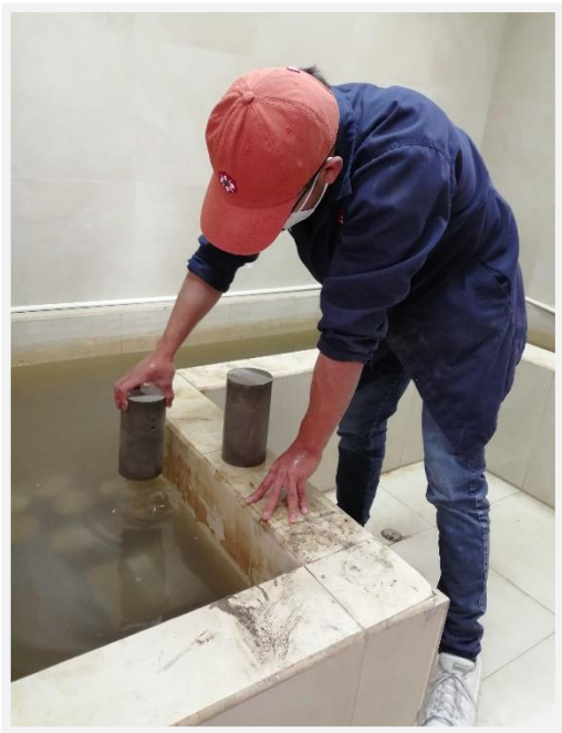
Fotografía 32. Colocación de cilindros en la cámara de curado
