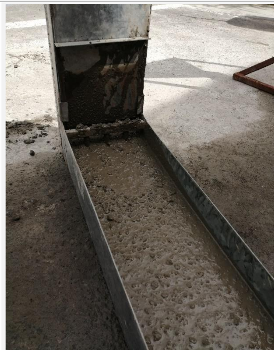
Fotografía 47. Hormigón fluyendo a través de las barras del ensayo de Caja L
