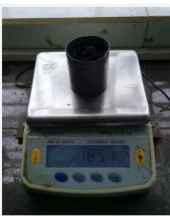
Fotografía 13. Pesaje de la muestra en SSS para determinar la cantidad de absorción
