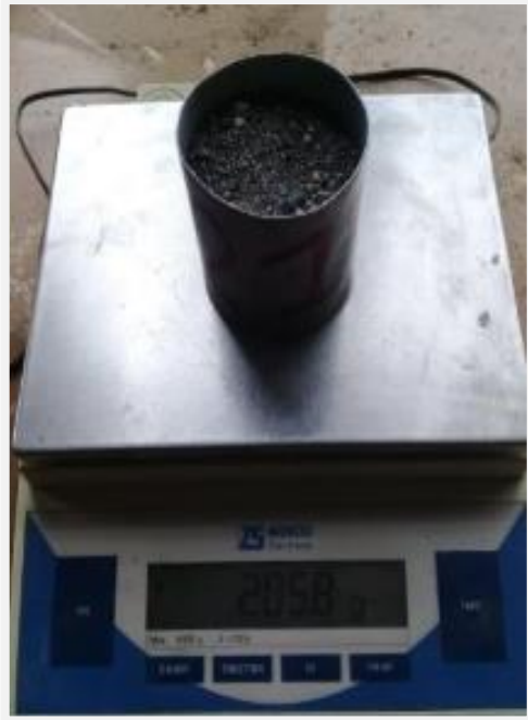
Fotografía 18. Pesaje de la muestra de agregado fino para capacidad de absorción
