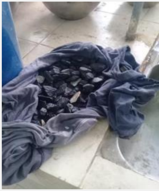
Fotografía 11. Secado de la muestra hasta alcanzar el estado (SSS)
