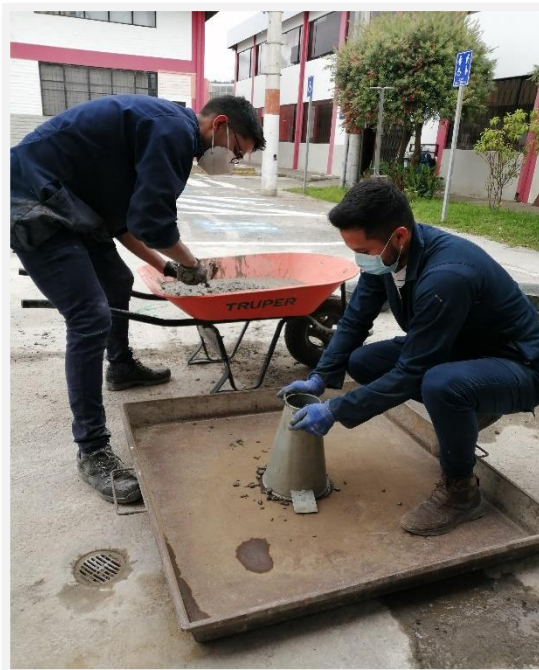
Fotografía 27. Ejecución del ensayo de cono de Abrams
