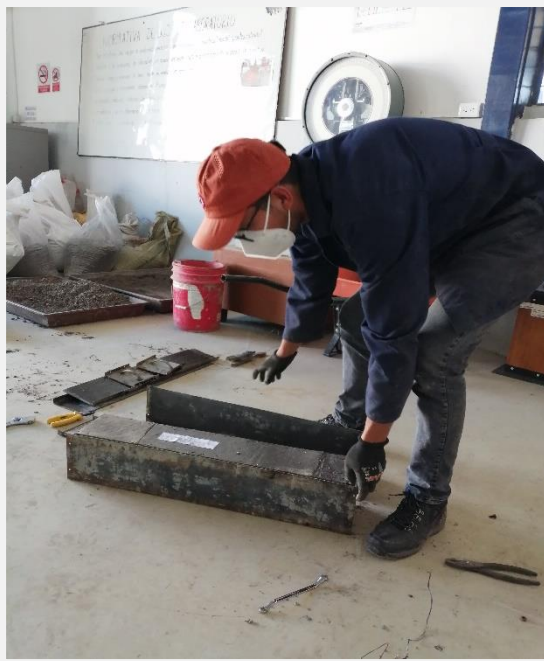
Fotografía 37. Desencofrado de las vigas de hormigón tradicional
