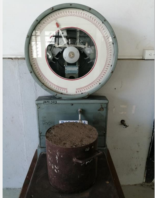
Fotografía 24. Pesaje del agregado compactado
