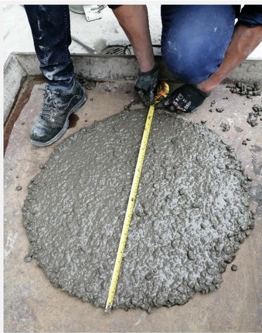
Fotografía 53. Colocación de mezcla en cono de Abrams para realización del ensayo “Slump Flow”
