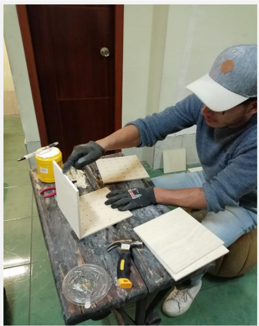
Fotografía 61. Elaboración de huecos para moldes de hormigón translúcido
