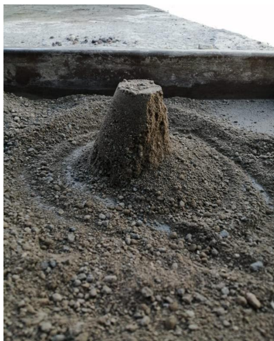
Fotografía 15. Verificación del estado SSS del agregado fino
