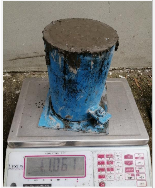
Fotografía 30. Pesaje de cilindros más hormigón tradicional
