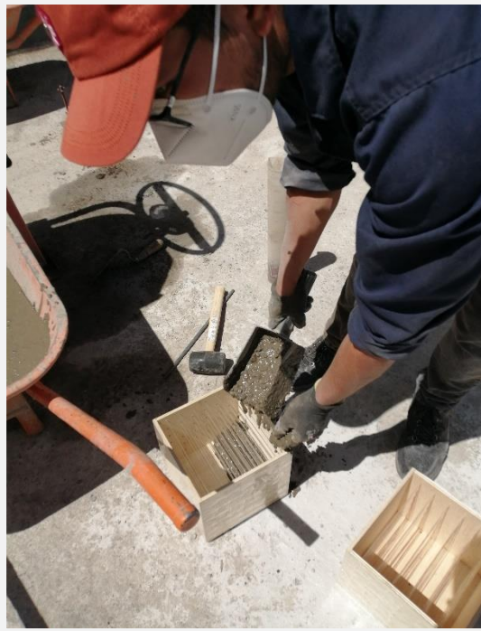
Fotografía 69. Colocación del hormigón en los moldes con fibra óptica
