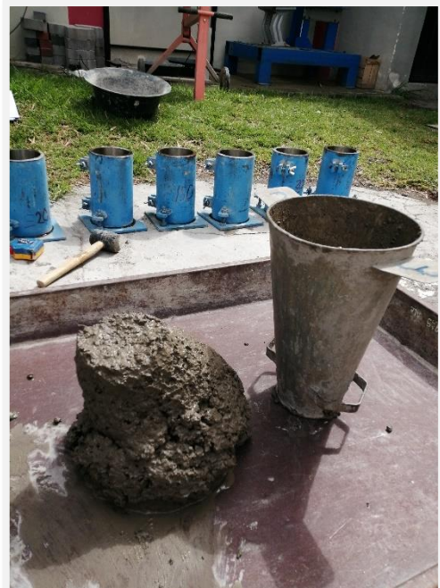
Fotografía 28. Resultado del ensayo de cono de Abrams
