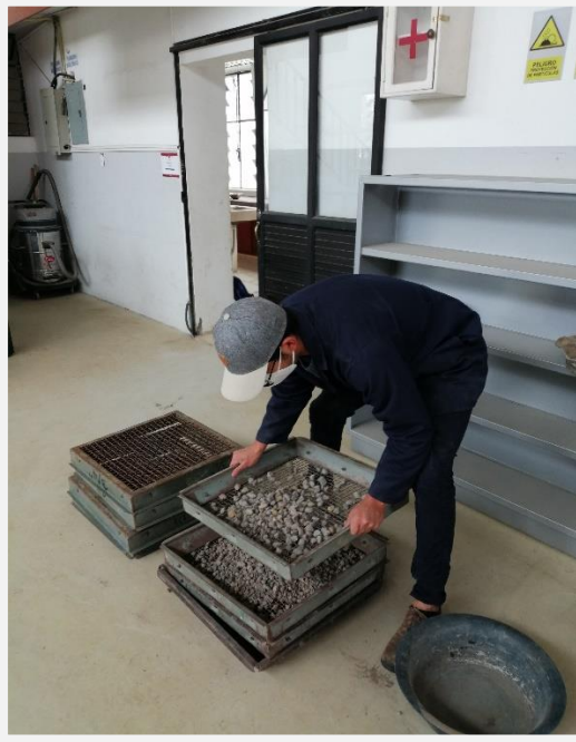
Fotografía 1. Tamizando el agregado grueso
