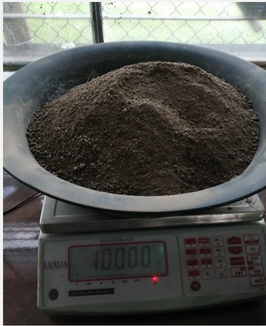
Fotografía 33. Pesaje de materiales para vigas de hormigón tradicional
