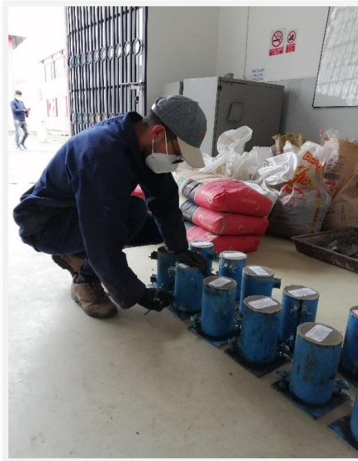
Fotografía 31. Desencofrado de cilindros de hormigón tradicional
