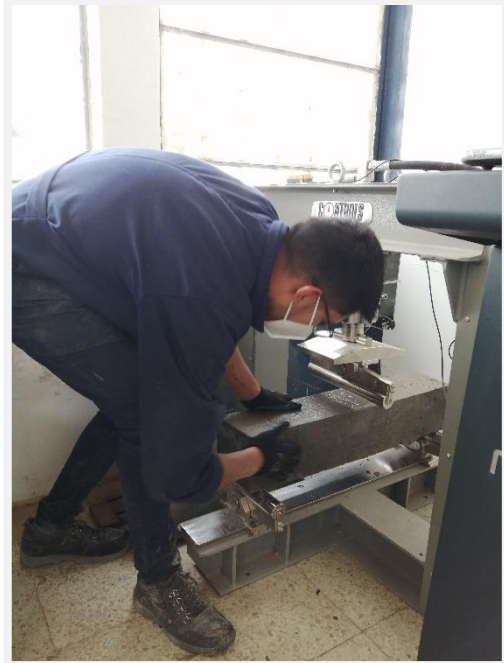
Fotografía 86. Colocación de las vigas en la máquina de ensayo
