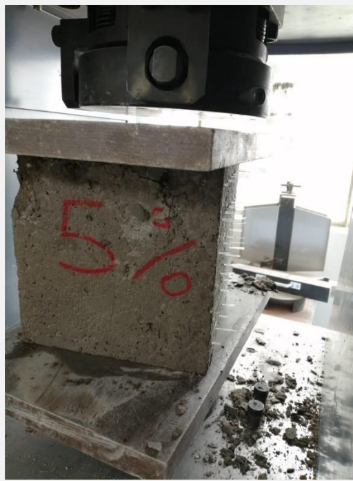
Fotografía 85. Rotura de cubo con el 5% de fibra óptica
