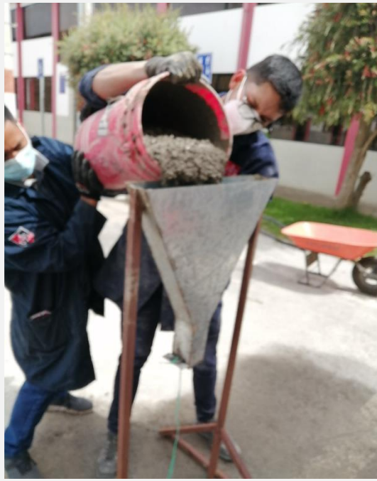
Fotografía 49. Vertido de la mezcla para realizar el ensayo de Embudo V
