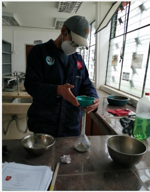
Fotografía 5. Colocando cemento en el picnómetro
