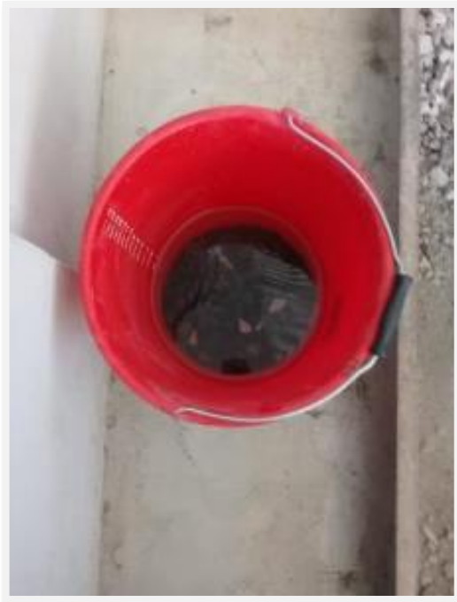
Fotografía 10. Muestra de agregado grueso sumergida en agua por 24 horas
