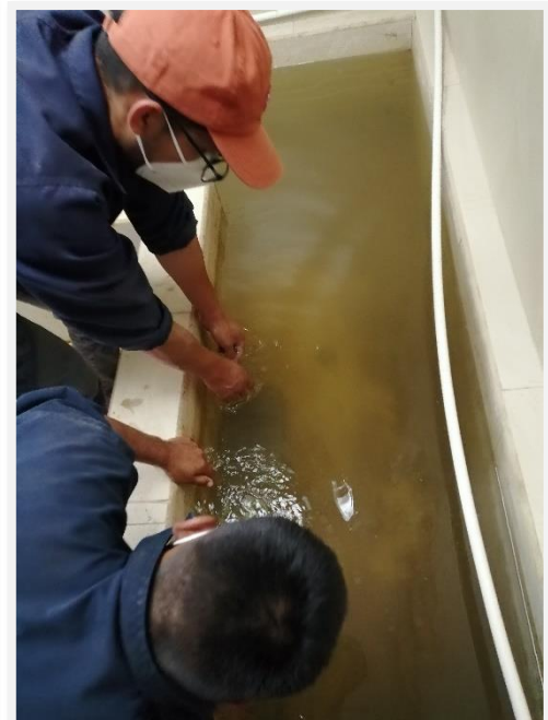
Fotografía 58. Colocación de cilindros en cámara de curado
