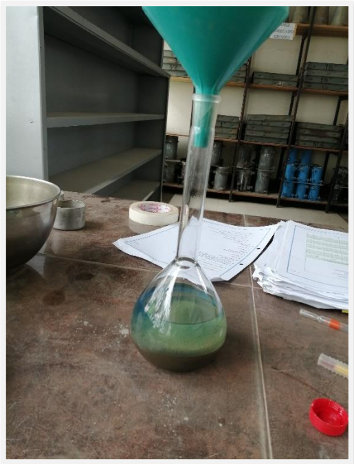
Fotografía 8. Completando la gasolina hasta la marca de aforo
