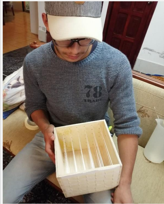
Fotografía 66. Colocación de los paquetes a través de los huecos del molde
