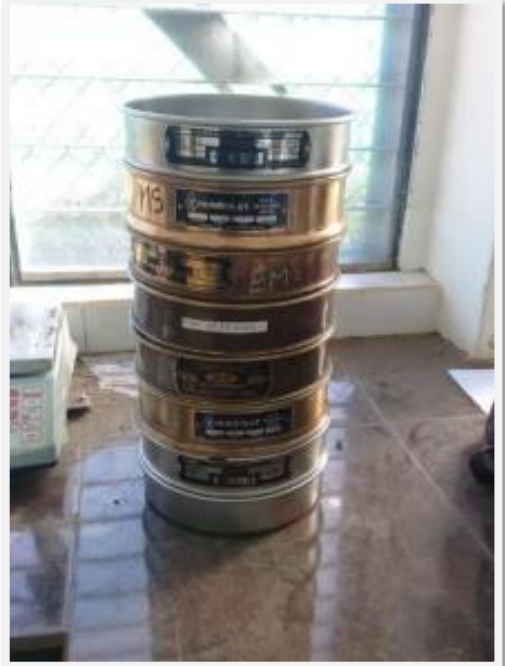
Fotografía 2. Tamizando el agregado fino
