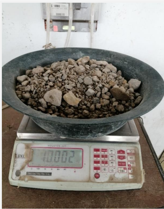
Fotografía 3. Pesando material para granulometría del agregado grueso
