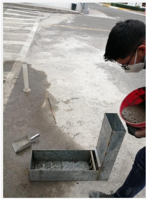
Fotografía 44. Colocación de mezcla en caja L para verificar propiedades de autocompactabilidad
