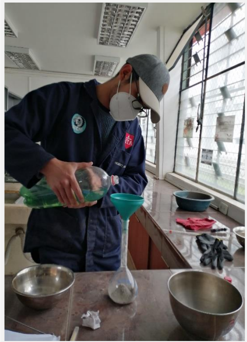
Fotografía 6. Colocando gasolina en el picnómetro
