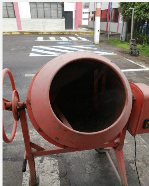
Fotografía 40. Mezcla de agregados pétreos, cemento y agua
