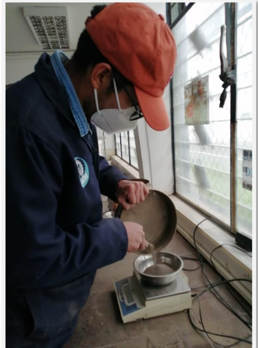
Fotografía 4. Pesando material retenido en el tamiz, agregado fino.
