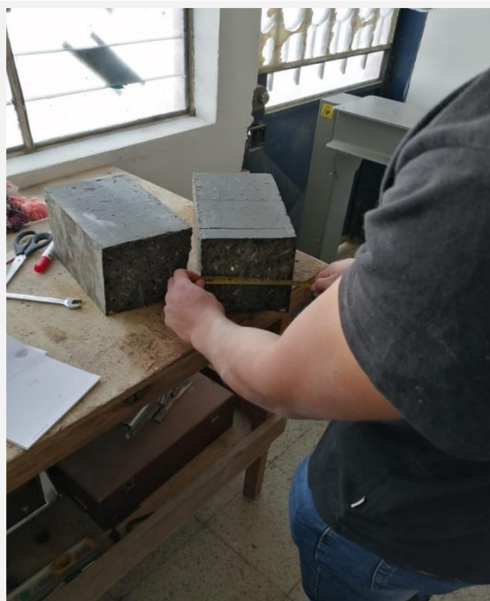
Fotografía 91. Medición de las dimensiones en donde se produjo la rotura en la viga de hormigón translúcido
