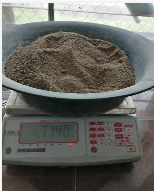
Fotografía 39. Pesaje de materiales para elaboración de cilindros de hormigón autocompactante
