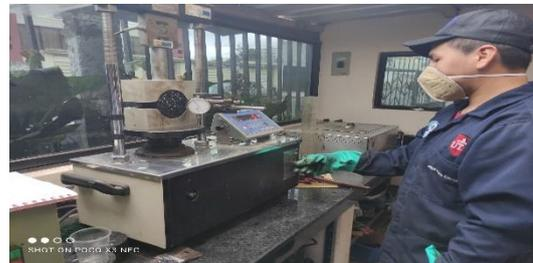
Ensayando las briquetas en la Máquina Marshall.
