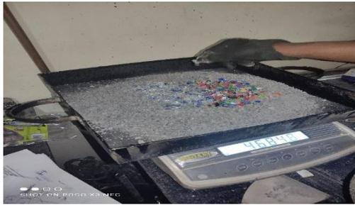
Colocando el polímero PET Y PP en la mezcla de agregados.
