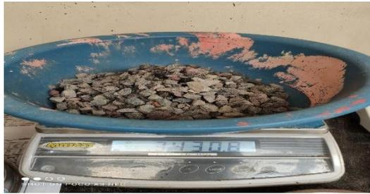
Pesando de la muestra a ser ensayada
