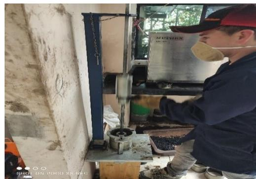
Compactando la mezcla asfáltica modificada.
