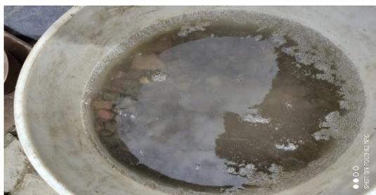
Muestra saturada de agregado grueso
