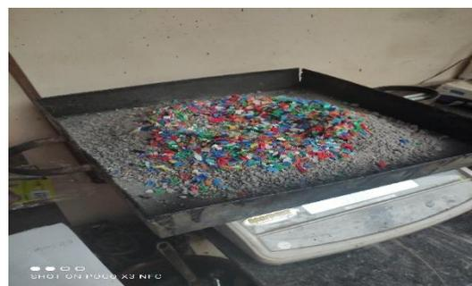
Colocando el polímero PP en la mezcla de agregados.
