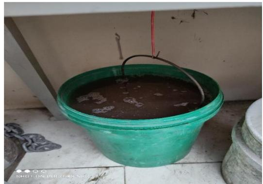
Muestra sumergida con la canastilla metálica
