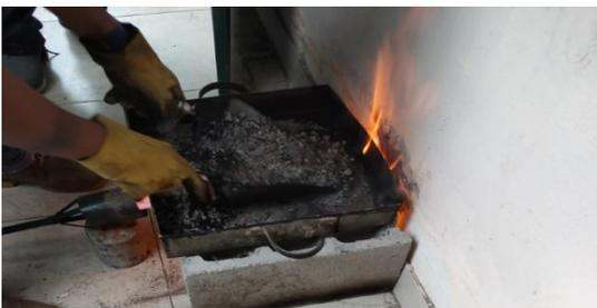
Mezclando los agregados con el cemento asfáltico.
