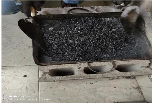
Mezcla homogénea de agregados con polímero y cemento asfáltico.
