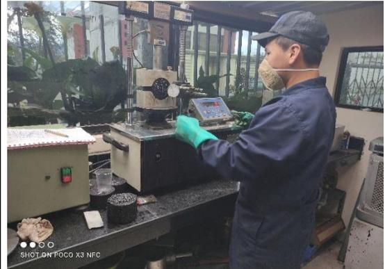
Ensayando a las briquetas con adición de polímeros en la Máquina Marshall.
