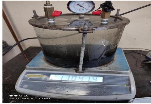
Peso del frasco + agua+ briqueta disgregada
