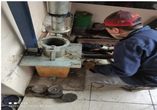
Colocando la mezcla asfáltica en el molde de compactación.
