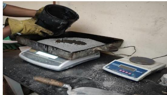
Vertiendo el cemento asfáltico en la mezcla de agregados.
