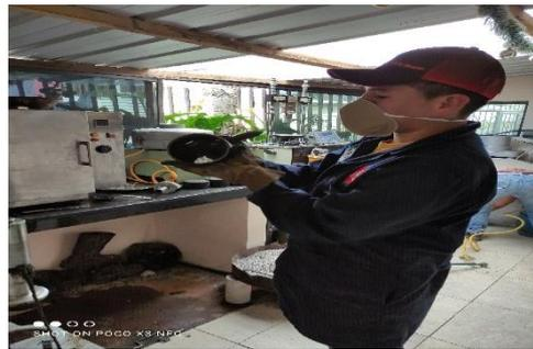
Colocando aceite en los moldes para la compactación de la mezcla.
