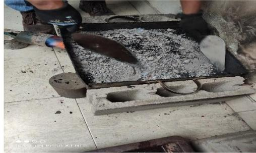
Mezclando agregados con polímero y cemento asfáltico.
