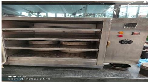
Muestras de agregado colocadas en el horno
