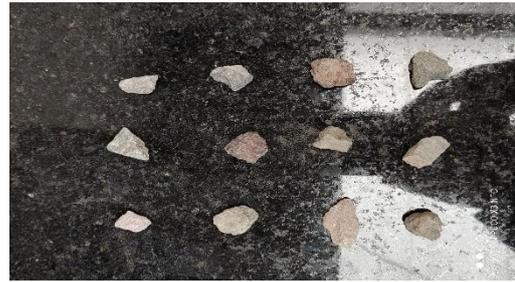
Inspección de las partículas fracturadas y no fracturadas.
