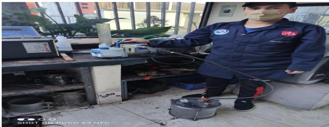
Realizando el ensayo rice con la máquina extractora de vacíos.
