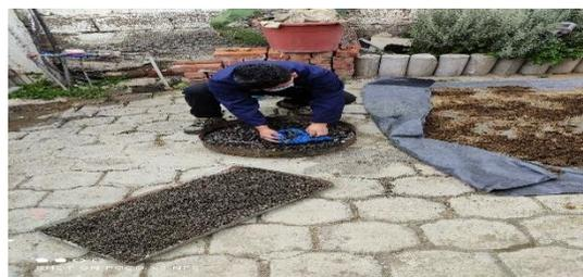
Secando la muestra saturada del agregado grueso
