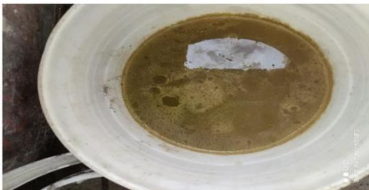
Muestra saturada de agregado fino
