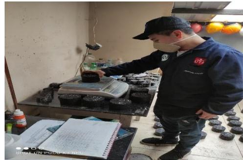
Pesando las briquetas de mezcla asfáltica convencional.
