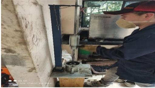
Compactando de la mezcla asfáltica convencional.
