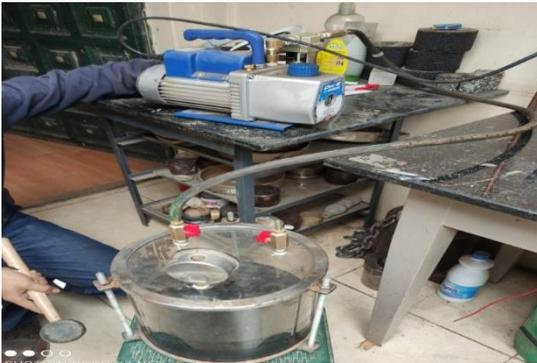
Máquina de extracción de vacíos
