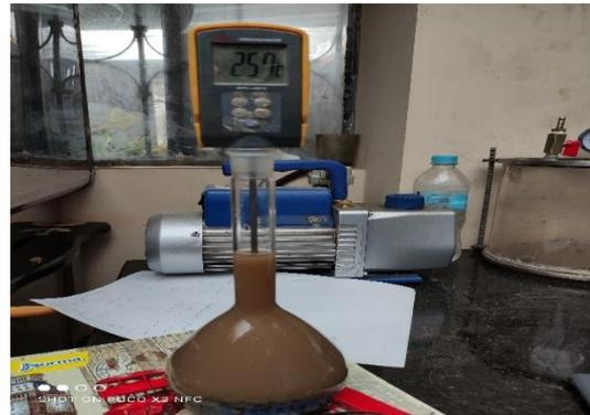
Temperatura del picnómetro con muestra sumergida
