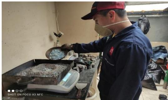
Colocando el polímero PET en la mezcla de agregados.
