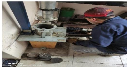
Colocando la mezcla asfáltica en el molde de compactación.
