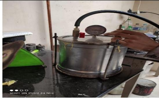
Colocando la briqueta disgregada en el frasco volumétrico.
