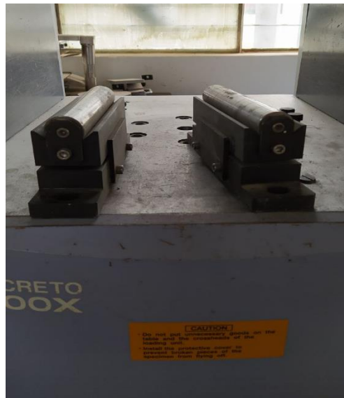
Figura 33. Colocando los apoyos para el ensayo
