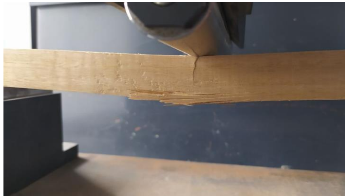
Figura 39. Falla por rotura de probeta
