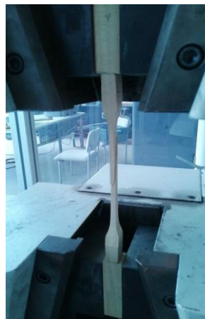
Figura 43. Probeta con fractura por esfuerzos aplicados.
