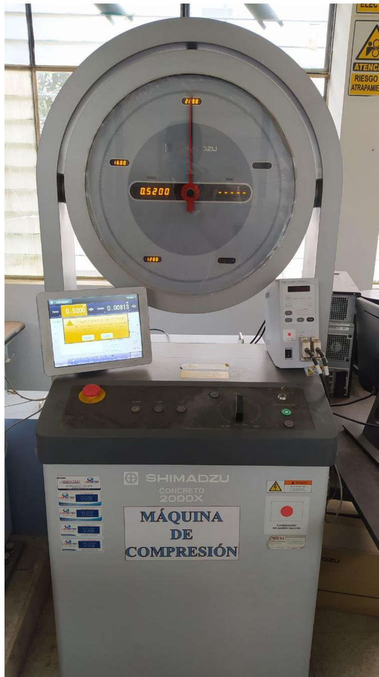
Figura 29. Máquina de compresión SHIMADZU CONCRETO 2000X
