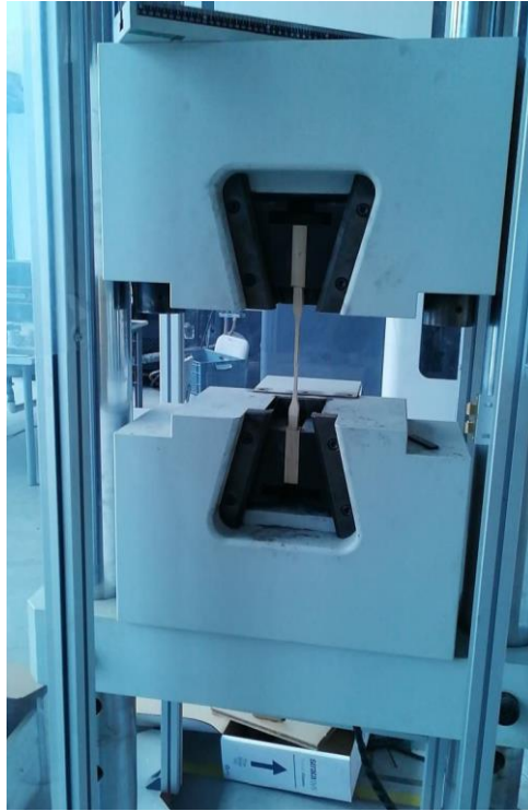
Figura 42. Probeta previamente al ensayo, ajustado las mordazas
