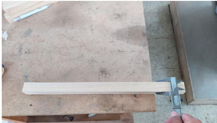
Figura 31. Midiendo probetas con calibrador
