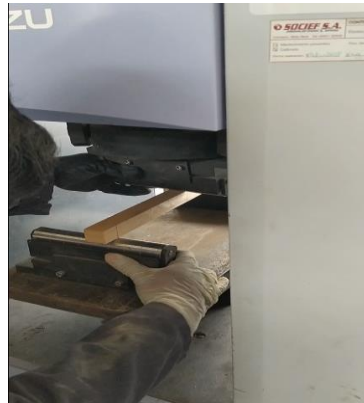
Figura 34. Colocando Probeta de madera
