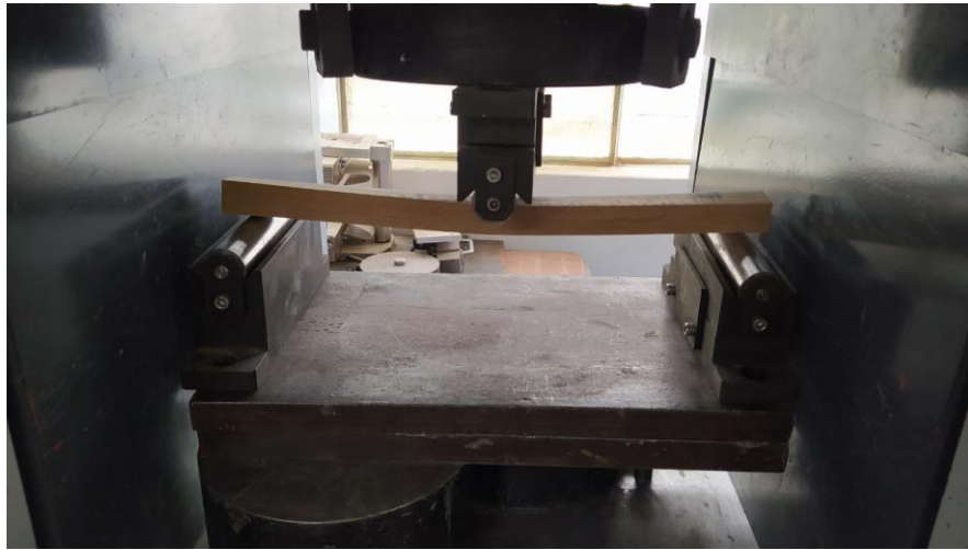
Figura 38. Probeta levemente flexionada por la aplicación de carga constante.
