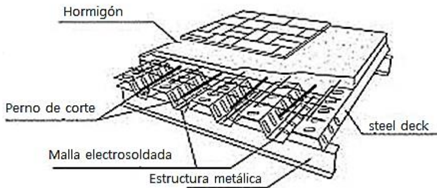
Figura 37: Detalle de losa Steel Deck.
