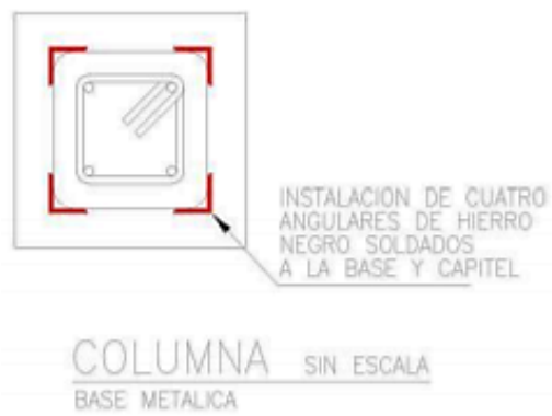
Figura 51: Instalación de los Ángulos Metálicos
