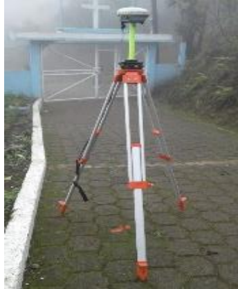
Colocación del 1er punto de control Cementerio General H antena =1.69
