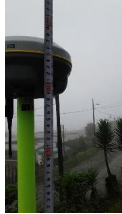
Colocación del 2do punto de control Infocentro Pinlopata H antena =1.398
