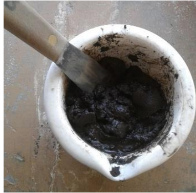
Suelo pulverizado (retenido en el tamiz #60, #100,#200, #400, fuente)
