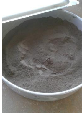
Suelo pulverizado (retenido en el tamiz #60, #100,#200, #400, fuente)
