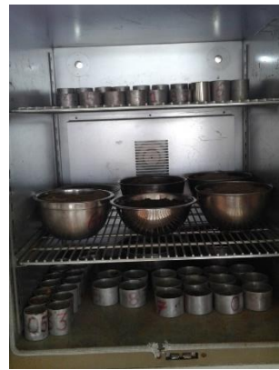
Secado de las muestras de 20 a 24 h a 105 – 110°C
