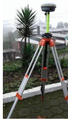
Colocación del 2do punto de control Infocentro Pinlopata H antena =1.398
