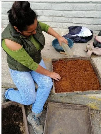
Pesar 6000 gr de suelo y mezclar con los % de agua requerido
