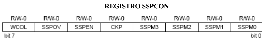
Figura A3. Registro de control SSPCON. Todos sus bits son leíbles y escribibles y se ponen a 0 tras un reset
