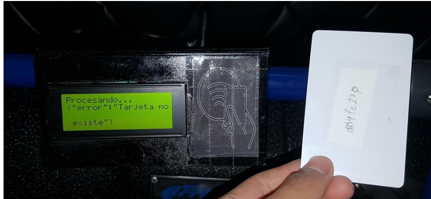
Figura 77: Proceso del cobro del pasaje con una tarjeta no registrada
