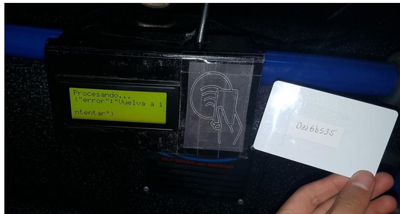
Figura 78: Proceso del cobro del pasaje con una tarjeta modificada ilegalmente
