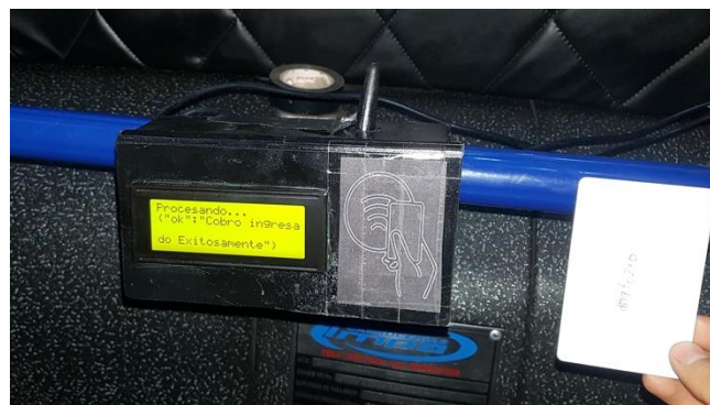
Figura 76: Proceso del cobro del pasaje Exitoso
