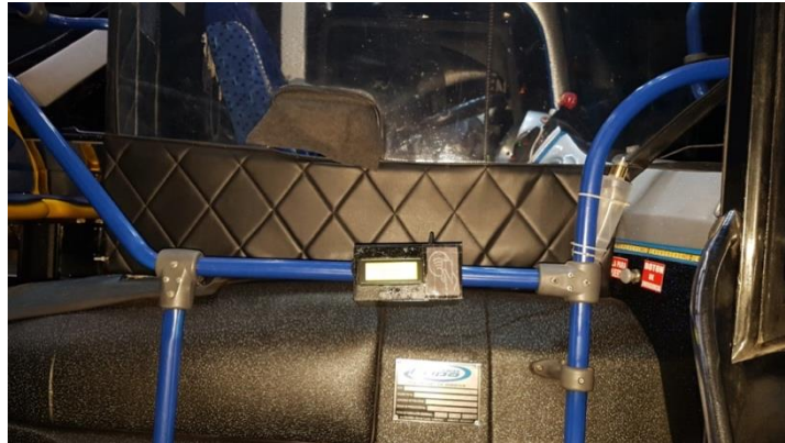
Figura 73: Implementación del lector de tarjetas NFC en una unidad de Transporte
