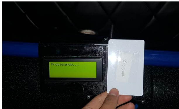
Figura 75: Proceso del cobro del pasaje
